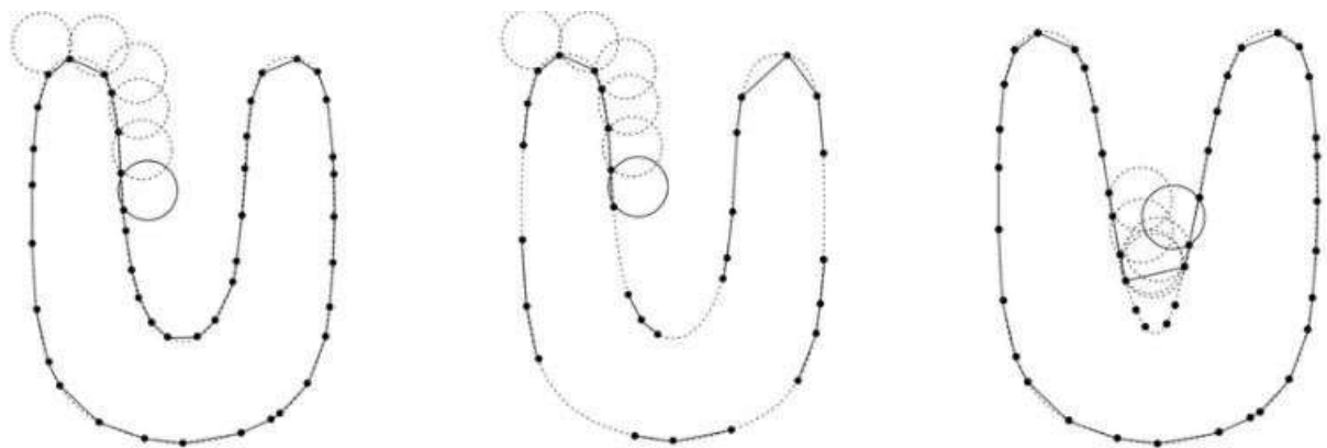
Hình 2.13: Quá trình hoạt động của Ball Pivoting Algorithm
