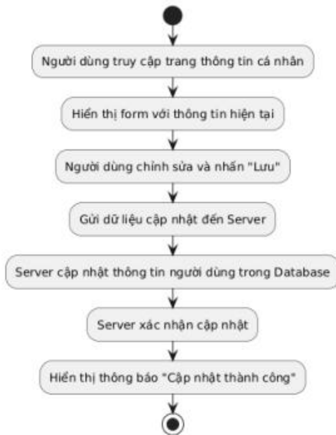
Hình 3.10 Biểu đồ hoạt động chức năng cập nhật thông tin người dùng Biểu đồ hoạt động chức năng thêm blog của admin
