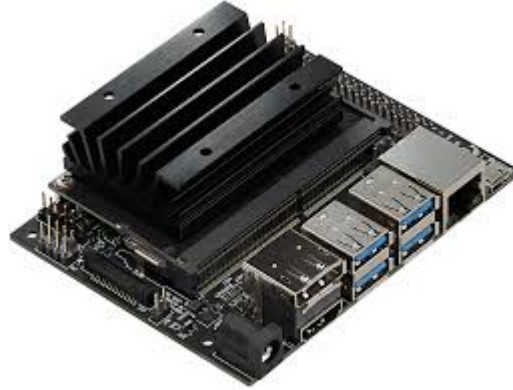
Hình 4.4. Thiết bị biên – Bộ Kit Phát Triển NVIDIA Jetson Nano B01 – được sử dụng trong nghiên cứu.
