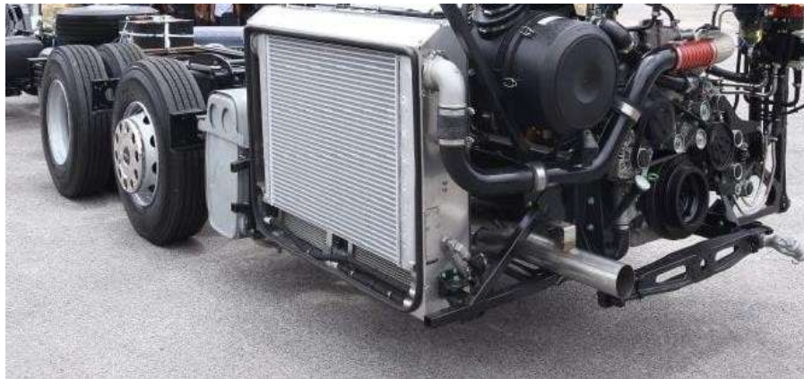
Hình 1.5. Hệ thống làm mát trên xe Bus bố trí dọc theo thân xe.
