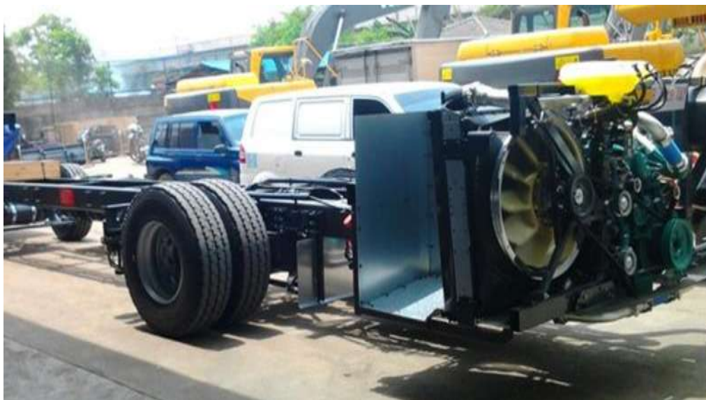
Hình 1.6. Hệ thống làm mát thiết kế ngang so với thân xe.
