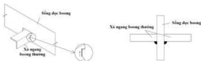
Hình 3.79 Gá cố định sống dọc boong và xà ngang boong với tôn boong
