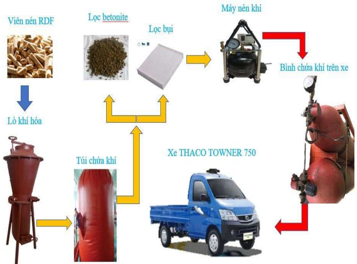
Hình 3.29. Quy trình nén khí vào bình
