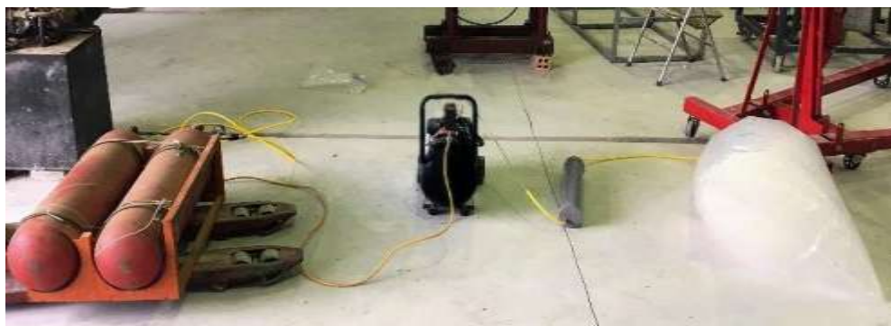
Hình 3.30. Hình ảnh thực nghiệm nén khí syngas vào bình chứa
