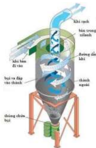
Hình 3.2. Sơ đồ nguyên lý cấu tạo Cyclone
