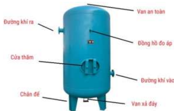
Hình 3.18. Cấu tạo bình chứa khí nén
