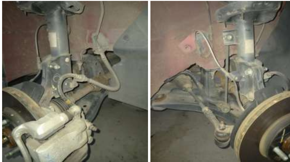
Hình 3.2. Hệ thống treo MacPherson trên cầu trước xe Hyundai Accent 2019
