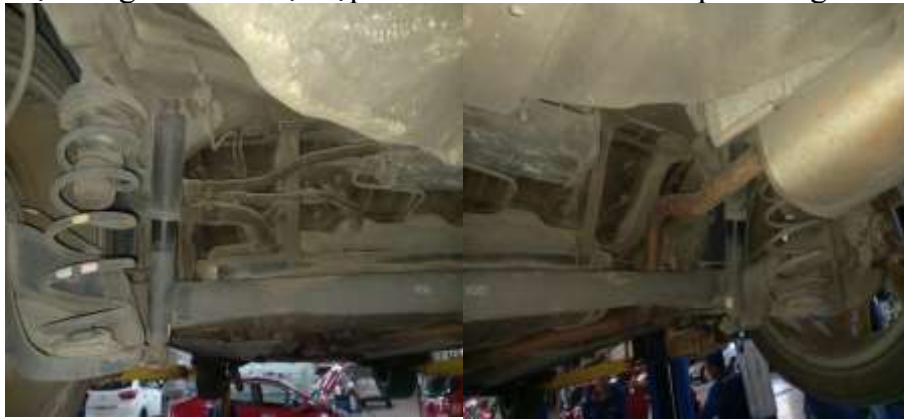
Hình 3.19. Hệ thống treo thanh xoắn trên cầu sau xe Hyundai Accent 2019
