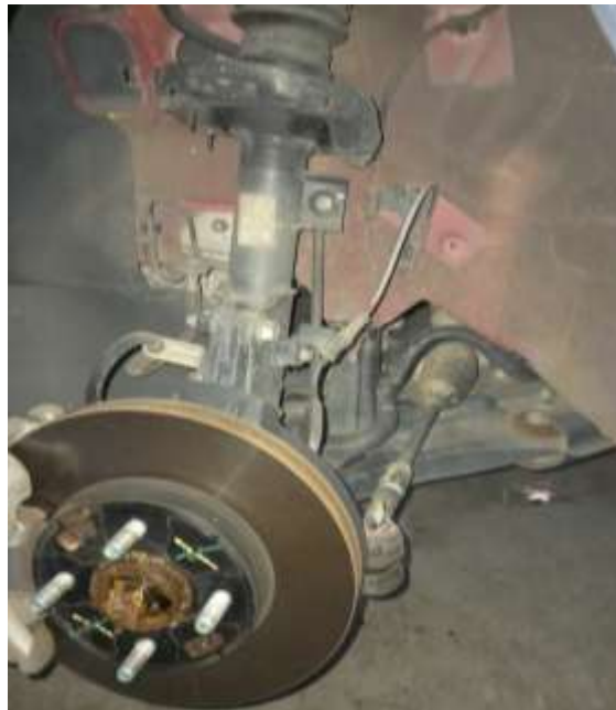
Hình 3.1. Hệ thống treo cầu trước xe Hyundai Accent 2019
