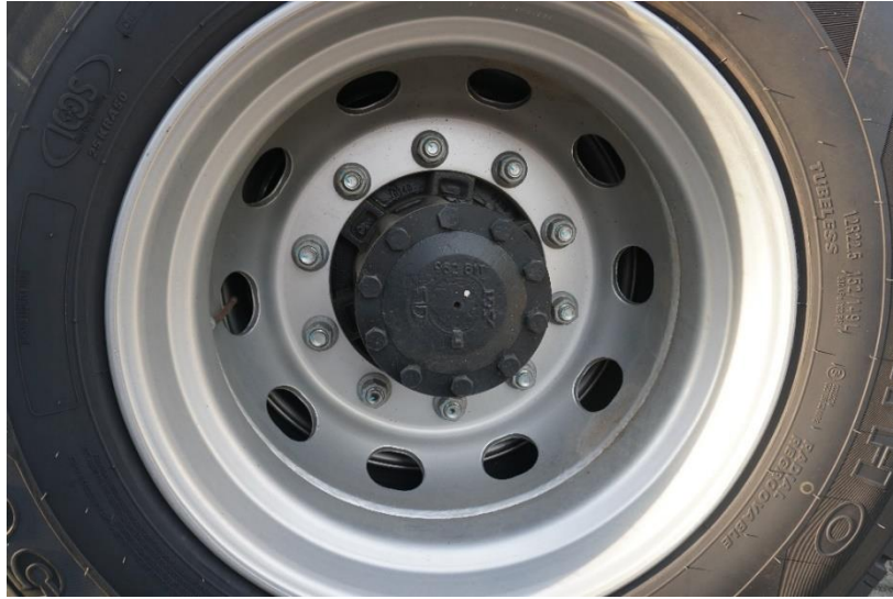
Hình 3.1.8 Mâm xe từ hợp kim sắt và cacbon
