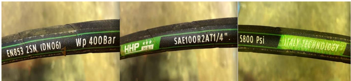
Hình 3.12 Đường ống thủy lực
