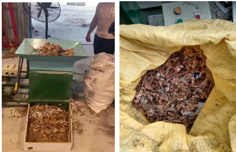
Hình 3.47 Quá trình nghiền chất thải rắn
