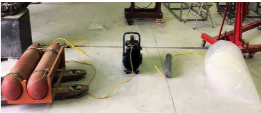
Hình 3.9. Hình ảnh thực nghiệm nén khí Biogas vào bình chứa
