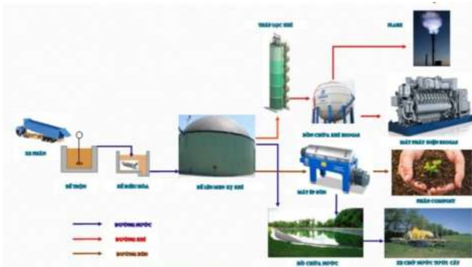
Hình 1.810- Quá trình sản xuất Biogas thực tế tại Việt Nam
