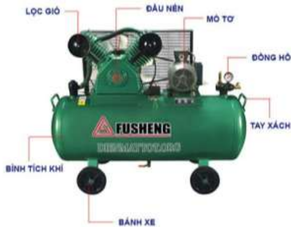
Hình 3.3. Cấu tạo máy nén piston
