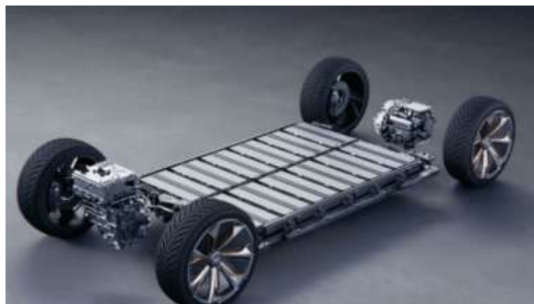
Hình 3.26. Pin cho xe ô tô điện cấu trúc phẳng tối ưu không gian xe
