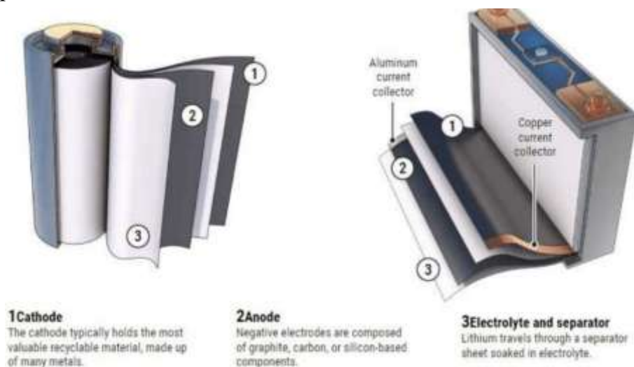
Hình 3.27. Pin cho xe ô tô điện hình trụ tối ưu nhiên liệu hiệu quả
