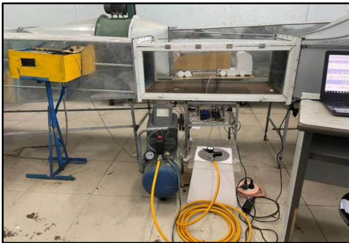
Hình 4. 16 Thí nghiệm với mô hình lắp bộ phun đều
