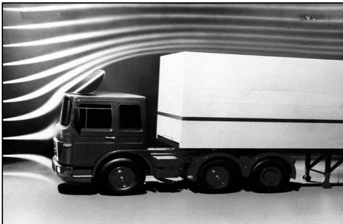
Hình 2. 2 Cánh mui lướt gió lắp trên xe tải
