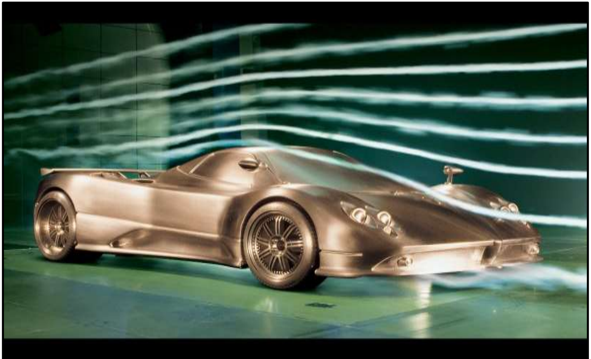
Hình 3. 3 Mô hình xe đua Pagani Zonda F đang được thí nghiệm trong ống khí động
