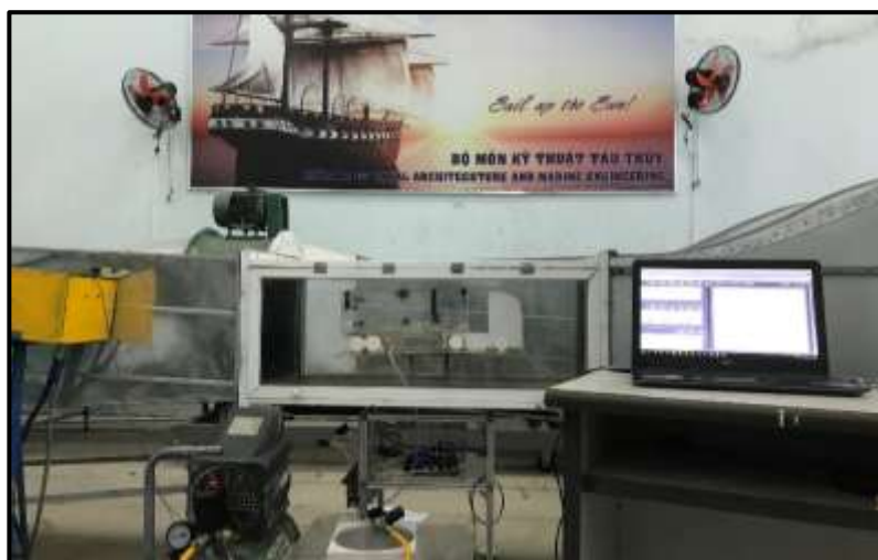
Hình 5. 13 Mẫu thử có hệ thống giảm lực cản sử dụng bộ dao động chất lỏng
