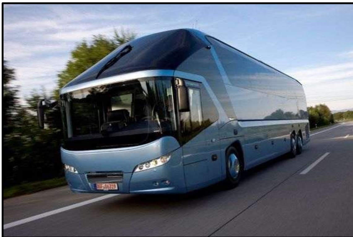
Hình 2. 3 Xe khách có phần đầu được thiết kế khí động học
