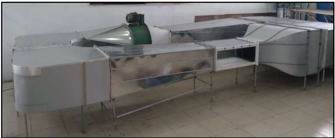
Hình 3. 10 Ống khí động vòng kín, cỡ nhỏ, tốc độ thấp tại phòng thí nghiệm Thủy khí
