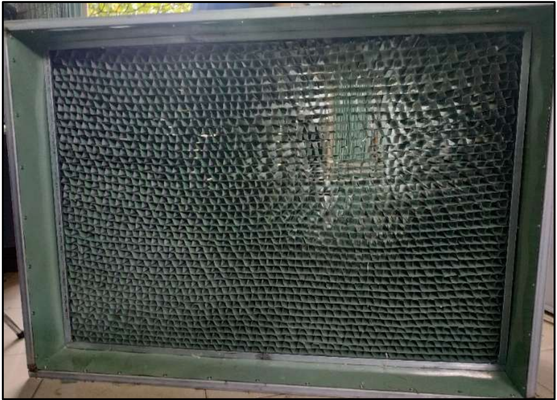
Hình 3. 15 Buồng ổn định với cấu trúc tổ ong
