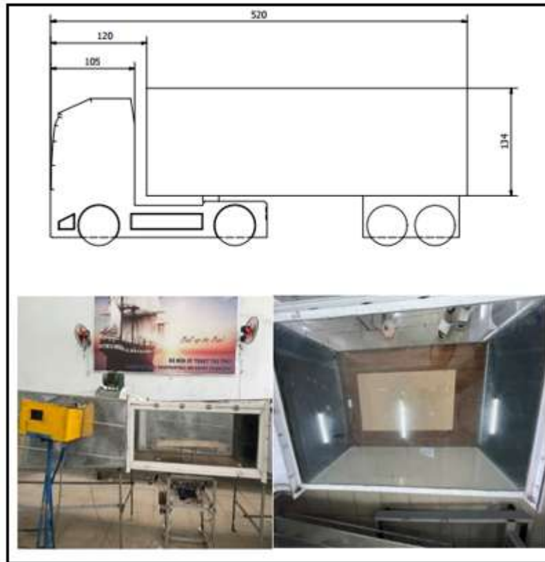
Hình 3. 33 Hình ảnh kích thước xe và bộ đỡ mô hình
