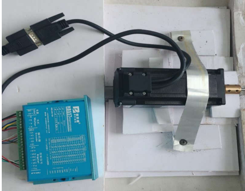
Hình 7.2 Lắp đặt servo motor chân vịt tàu mô hình
