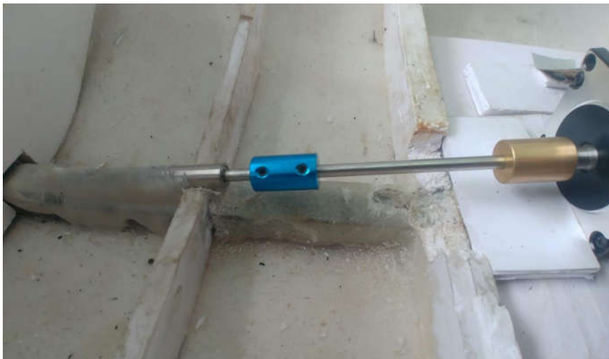
Hình 7.3 Lắp đặt trục chân vịt tàu mô hình
