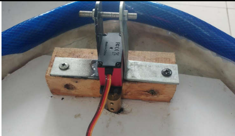
Hình 7.4 Lắp đặt Servo lái
