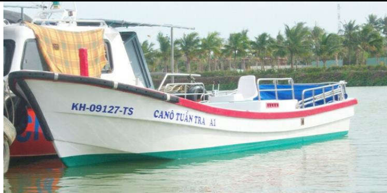
Hình 6.3 Cano tuần tra bằng vật liệu composite
