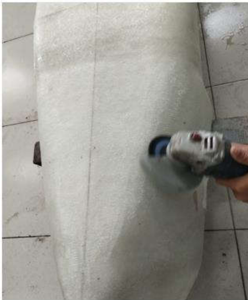
Hình 6.18 Mài nhẵn bề mặt vỏ tàu
