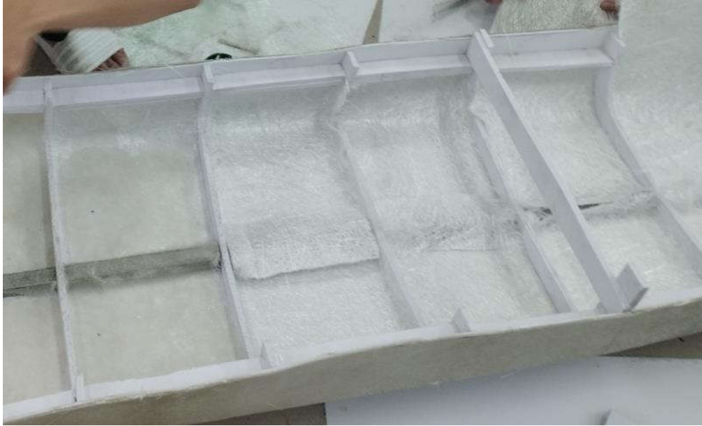
Hình 6.17 Quét keo, trải sợi thủy tinh mặt trong
