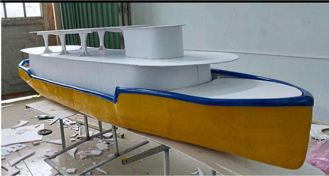
Hình 6.22 Hoàn thiện thượng tầng
