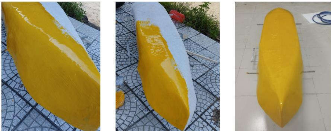
Hình 6.21 Sơn và hoàn thiện vỏ tàu
