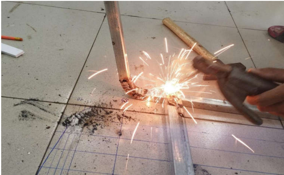
Hình 6.11 Cắt, nén và hàn sổng chính theo biên dạng
