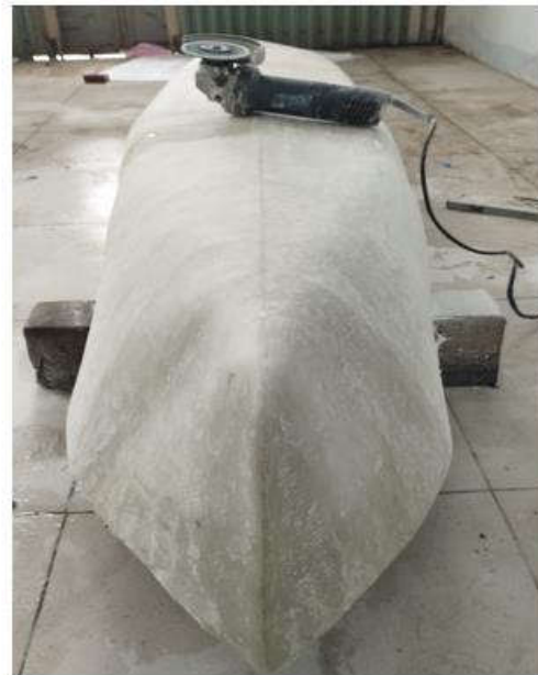
Hình 6.18 Mài nhẵn bề mặt vỏ tàu
