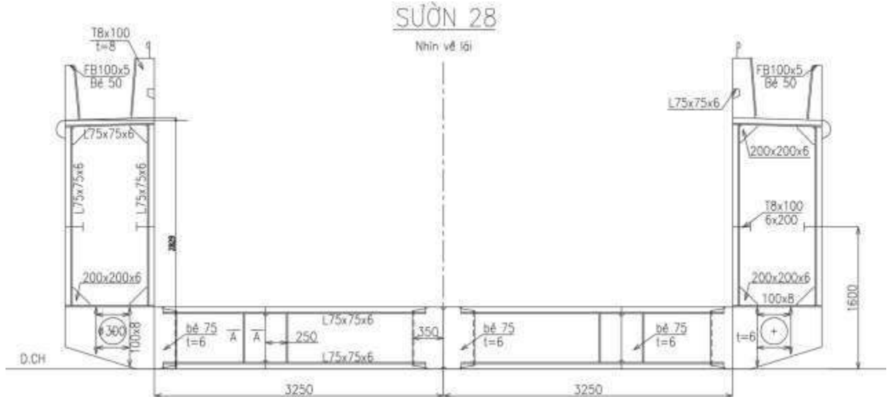
Hình 1.11 Kết cấu sườn 28.
