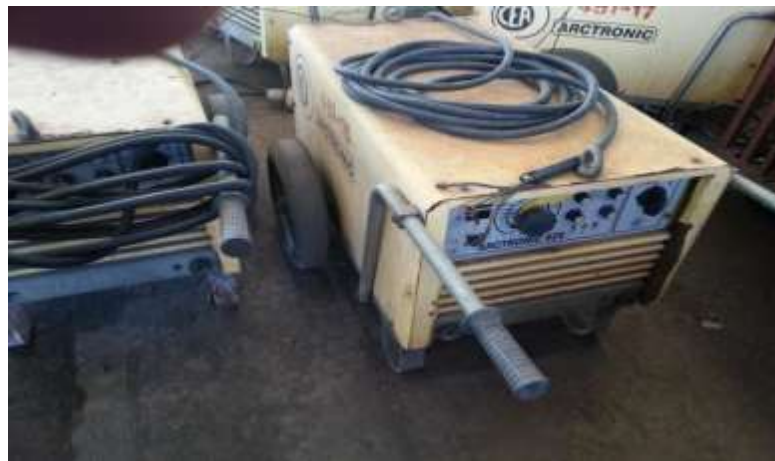
Hình 2.6 Máy hàn que Arctronic 426.
