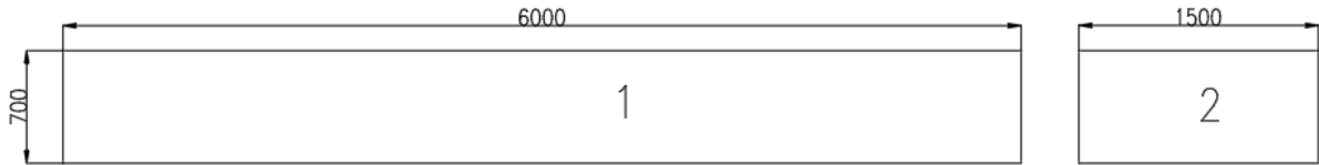
Hình 3.22 Khổ tôn sống chính ,và mạn trong phần đáy.
