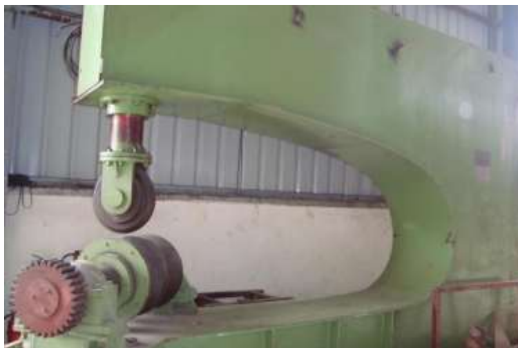
Hình 4.8 Uốn cong tôn trên máy lóc tôn
