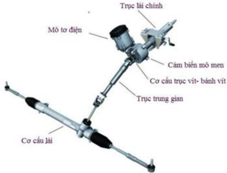
Hình 2.1. Trợ lực lái điện với moto trợ lực trên trục lái.
