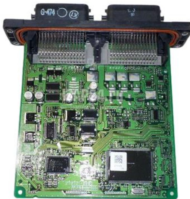
Hình 2.21. Mạch điện bên trong ECU EPS
