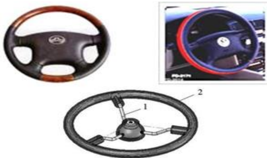
Hình 1.1. Cấu tạo vô lăng (vành lái).
