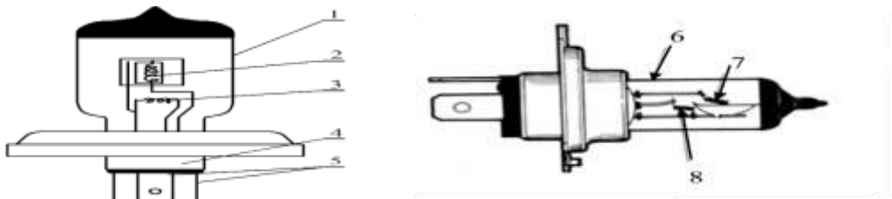
Hình 2.20: Cấu tạo bóng đèn halogen.
