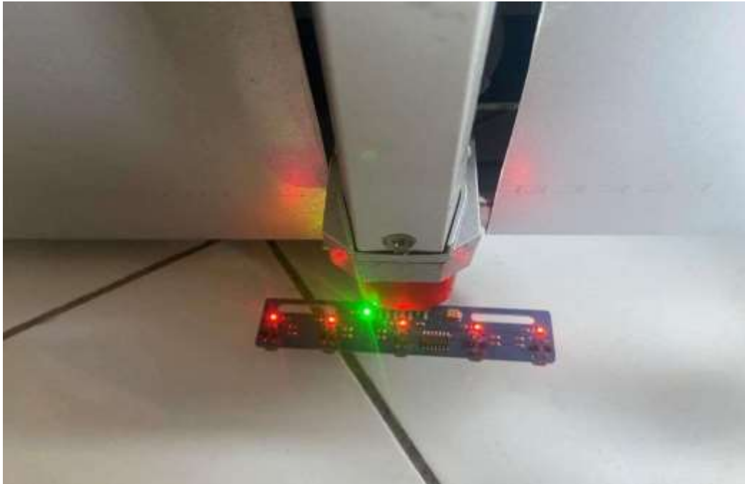
Hình 4. 8: Vị trí lắp đặt cảm biến dò line
