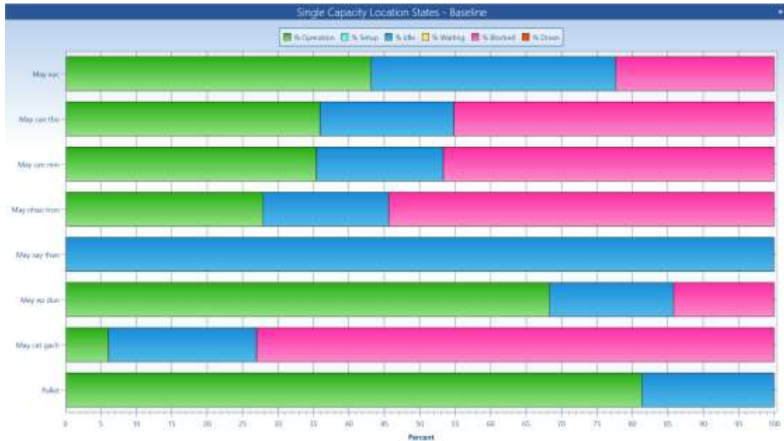
Hình 3-36: Biểu đồ trạng thái các máy có dòng nguyên vật liệu đi qua
