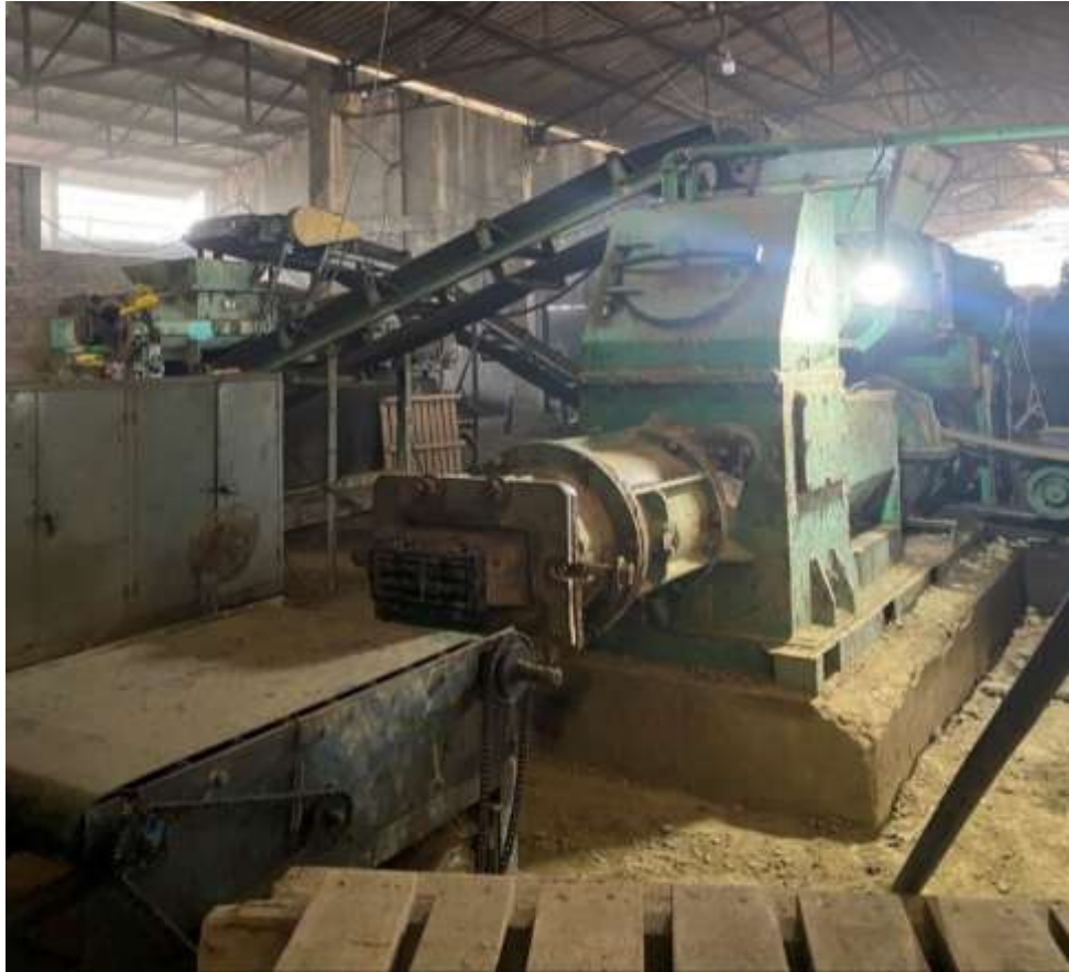
Hình 4-16: Máy ép đùn gạch mộc tại nhà máy
