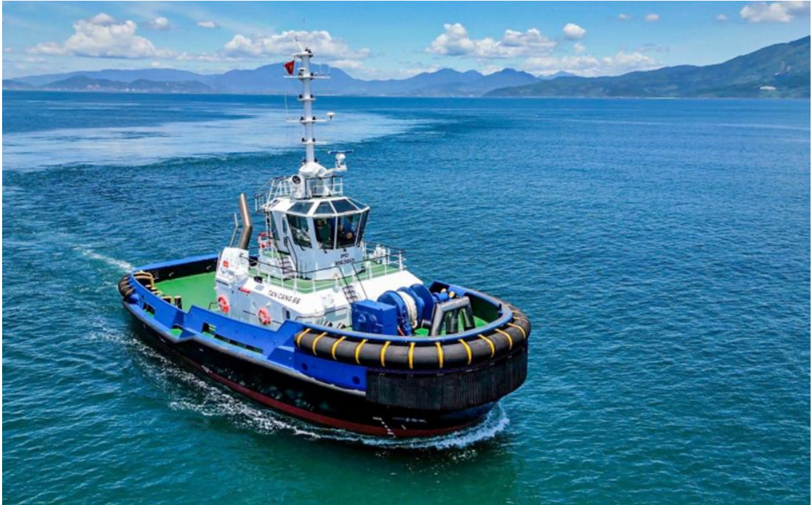
Hình 1.7 Tàu lai dết ASD2811
