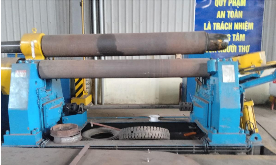
Hình 1.23 Máy lốc tôn 3 trục điều khiển PLC
