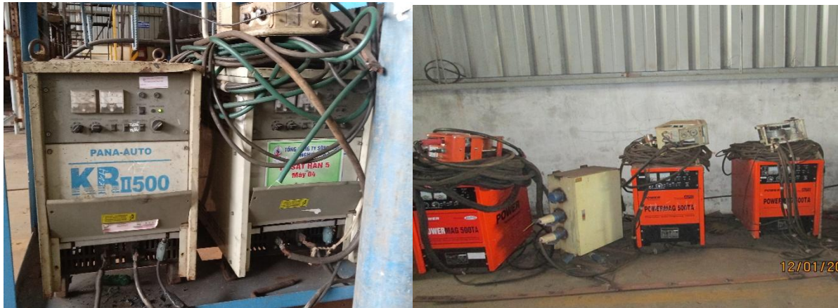
Hình 1.28 Các loại máy hàn dùng trong phân xưởng
