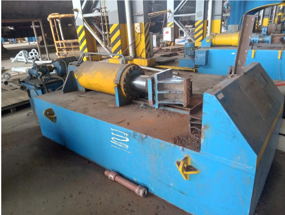
Hình 1.26 Máy ép ngang 400T
