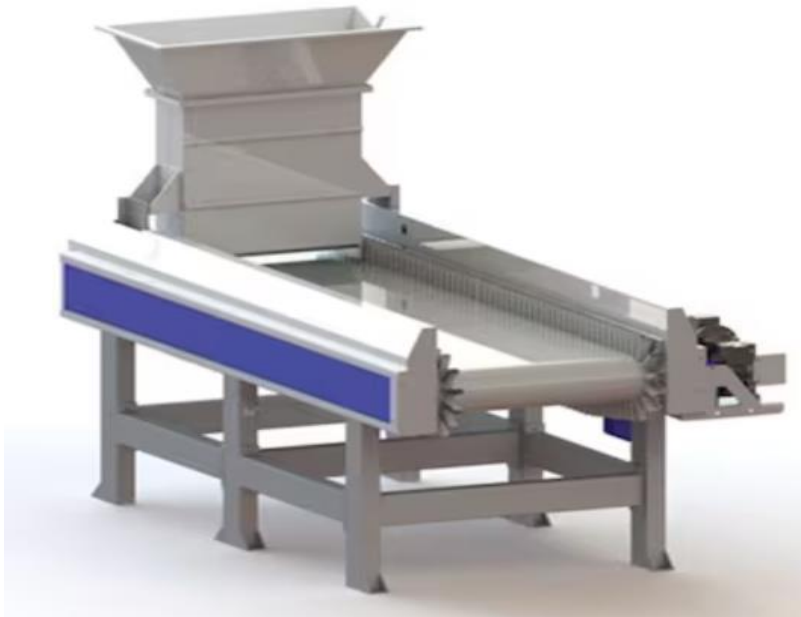
Hình 2.1 Băng chuyền cho sản phẩm rời
