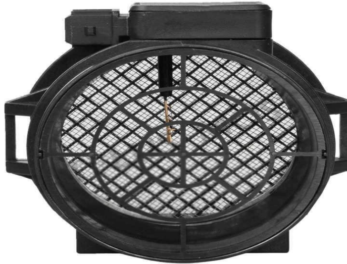
HÌNH 3.16 Vị trí Cảm biến lưu lượng khí nạp (loại dây nhiệt)
