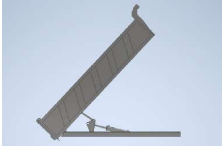
Hình 9.9. Cơ cấu nâng hạ thùng
