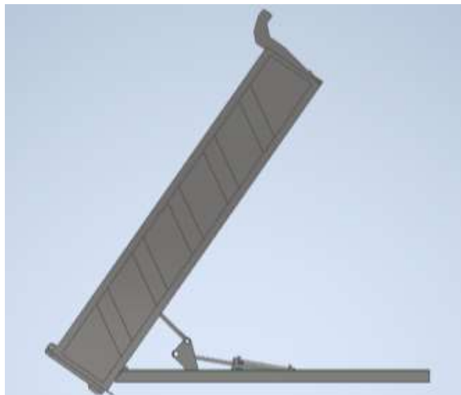
Hình 9.24. Hệ thống nâng ở vị trí lớn nhất
