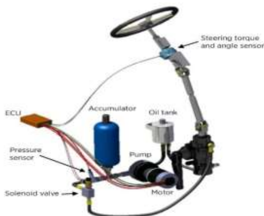
Hình 6.9. Hệ thống lái điện – thủy lực
