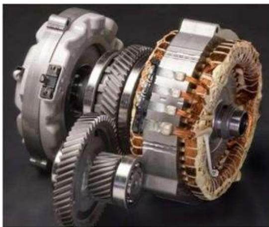
Hình 8.17: Động cơ điện xoay chiều cảm ứng trên Toyota Prius
