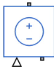
Hình 8.31: Nguồn cung cấp năng lượng điều khiển
