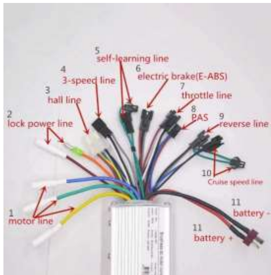
Hình 7.4: Phân loại dây chức năng của bộ điều tốc động cơ BLDC HDK-24G-60A-80-A
