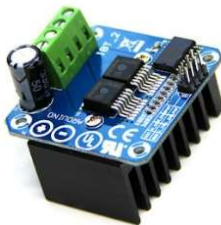
Hình 7.5: Bộ điều khiển động cơ DC BTS7960
