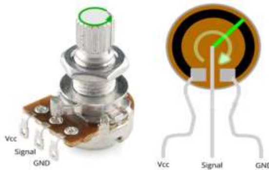
Hình 7.8: Sơ đồ 3 chân của biến trở B10K
