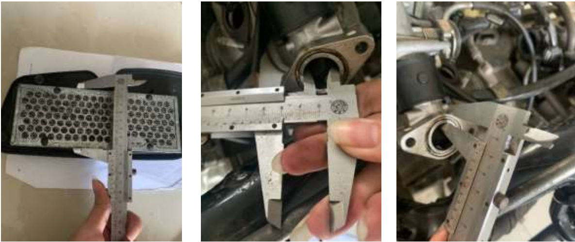
Hình 3.4. Quy trình đo đặc thông số khi sử dụng thước kẹp
