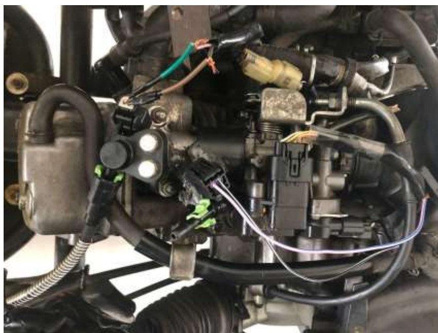
Hình 4.12. Động cơ sau khi lắp thêm vòi phun côn
