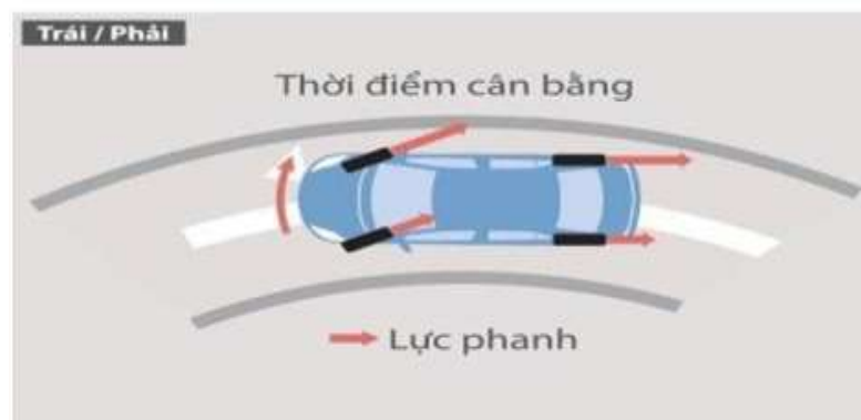
Hình 3.22. Lực phanh ở các bánh xe khi xe vào cua
