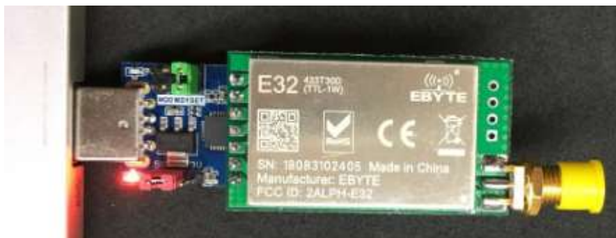
Kết nối module AS15-USB-T2 với cổng USB máy tính
