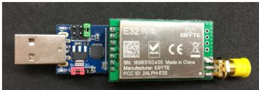
Cắm module E32-TTL-1W lên module AS15-USB-T2
