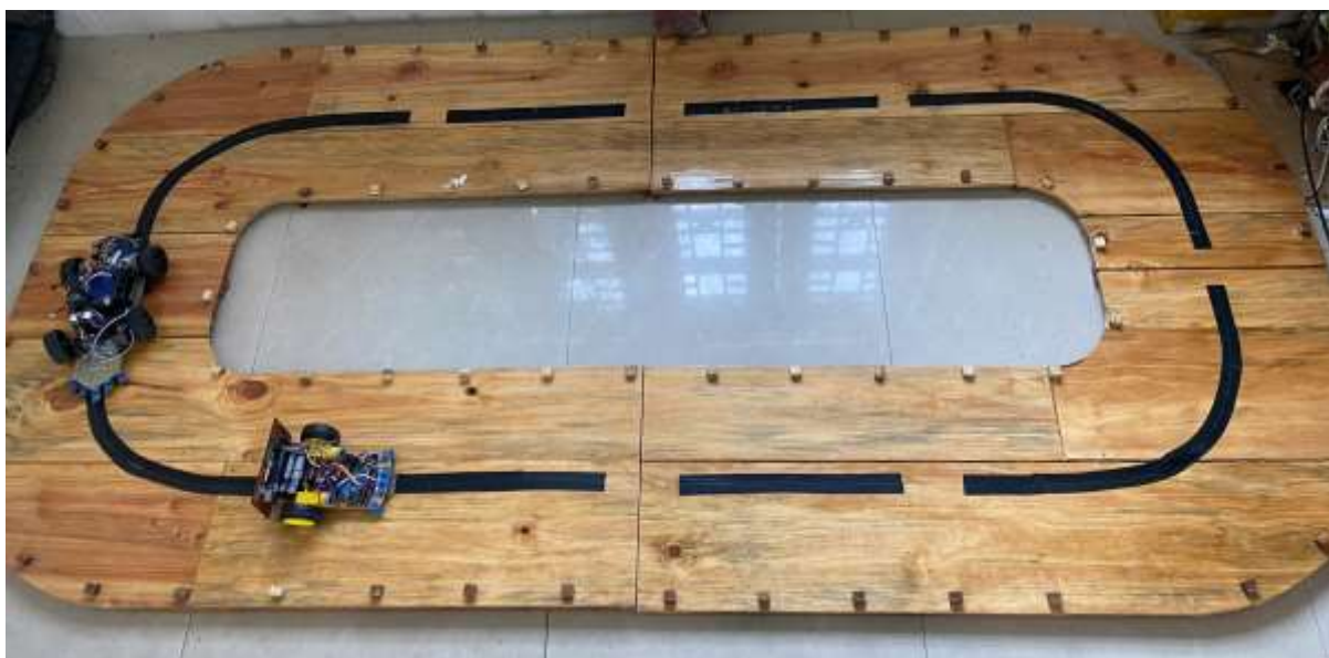
Hình 3.24 Thiết kế và chế tạo đường sa bàn
