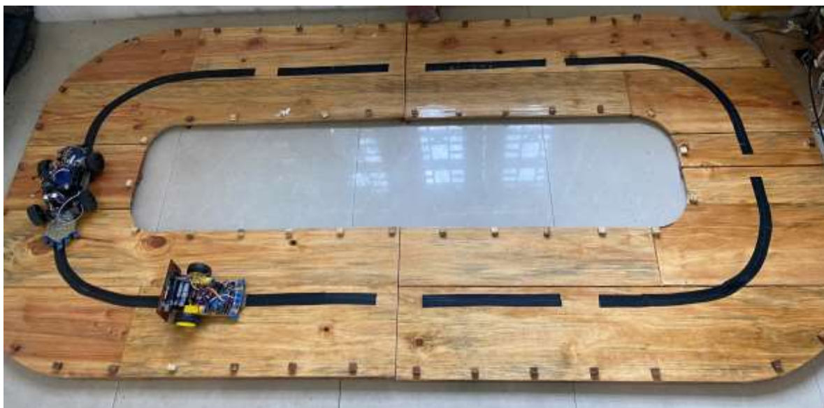
Hình 6.1 Chạy thực nghiệm robot dò line
