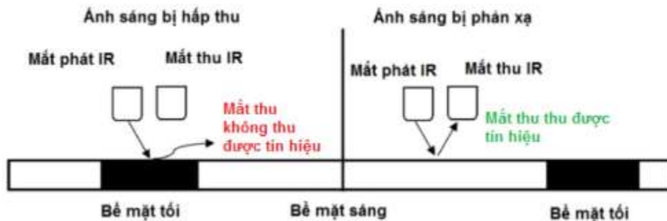
Hình 4.24 Cơ chế hoạt động của cảm biến
