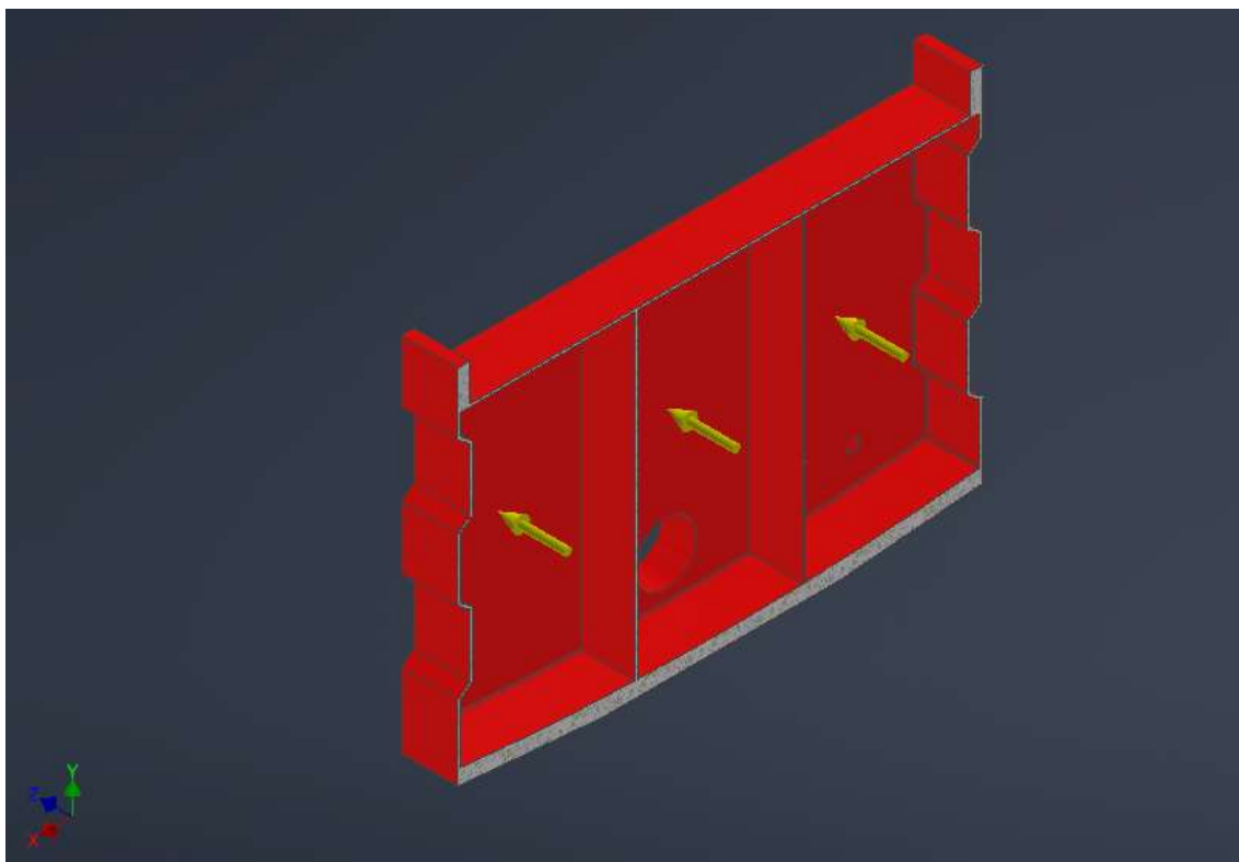
c. Điều kiện biên tại mặt trước xi-téc bọt khi xe phanh gấp
