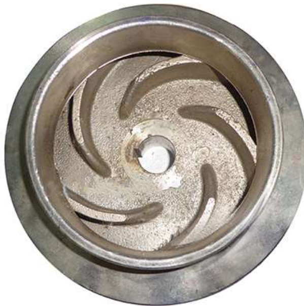
Hình 5.10. Cánh bơm ly tâm dạng cánh cong trụ (dạng khép kín).
