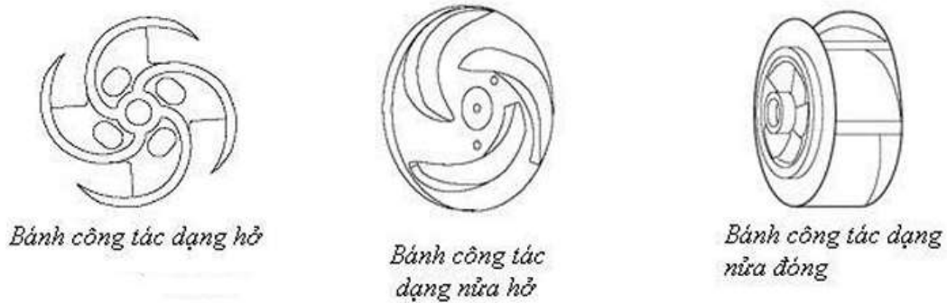
Hình 5.2. Một số hình dạng bánh công tác của bơm ly tâm.
