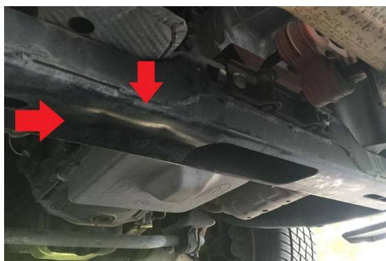
Hình 2. 2: Khung xe bị cong vênh ảnh hưởng đến khả năng chịu lực của xe
