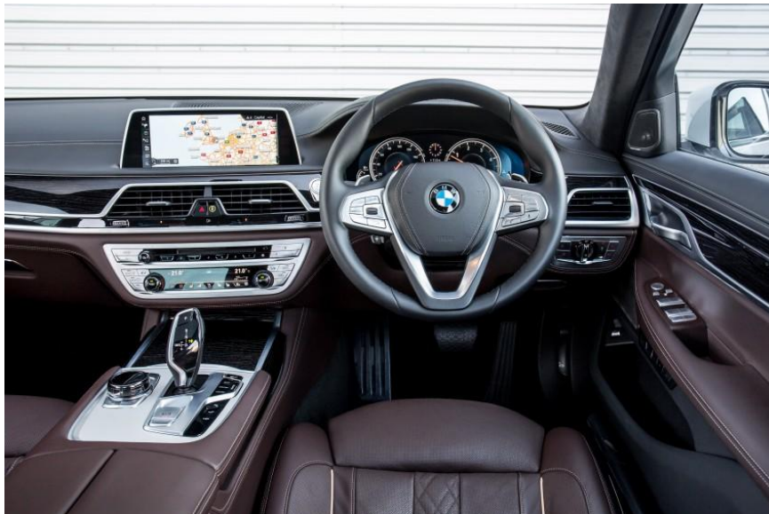
Hình 2.3: Hệ thống lái có vành lái bên phải
