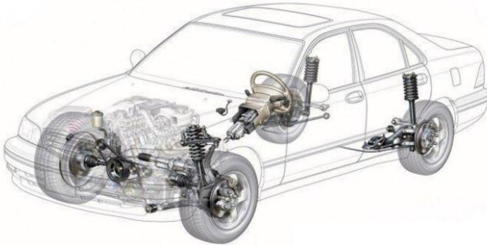
Hình 2.1: Tổng quan hệ thống lái trên ô tô
