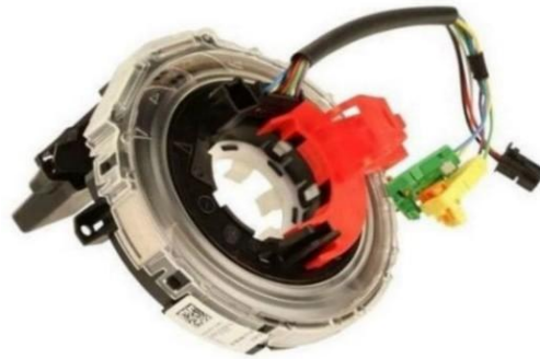
Hình 2.10: Cấu tạo cảm biến góc lái
