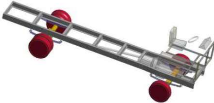
Hình 1.10: Kết cấu sàn xe khách kiểu chung
