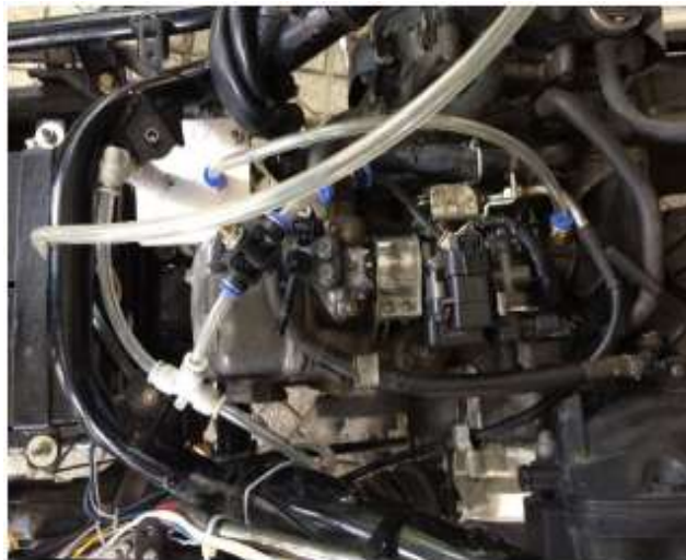
Hình 4.8 Bố trí hệ thống cung cấp
