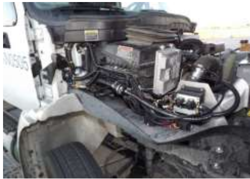
Hình 1.24 Bộ dụng cụ chuyển đổi động cơ diesel và khí tương thích với hydro và amoniac
