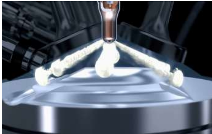
Hình 1.27 Hệ thống kim phun trong động cơ sử dụng amoniac
