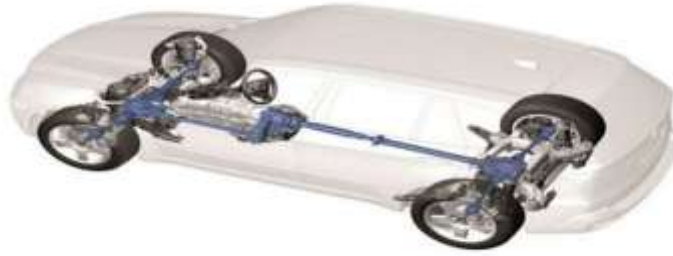
Hình 1.9 Kết cấu của 4WD có vi sai trước và 1 hệ thống truyền lực
