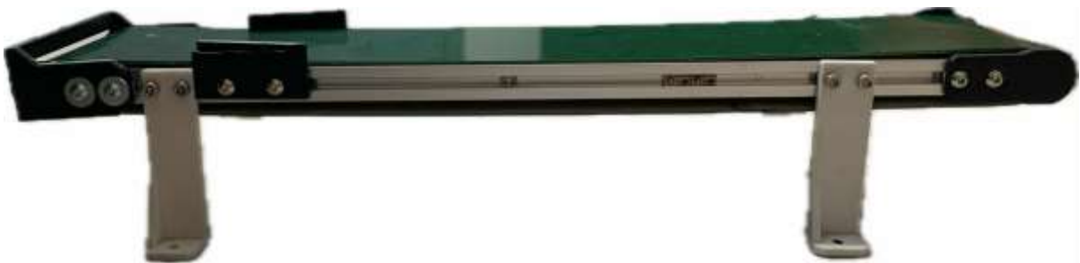
Hình 6.17 Hệ thống băng tải sau khi đã được lắp ráp
