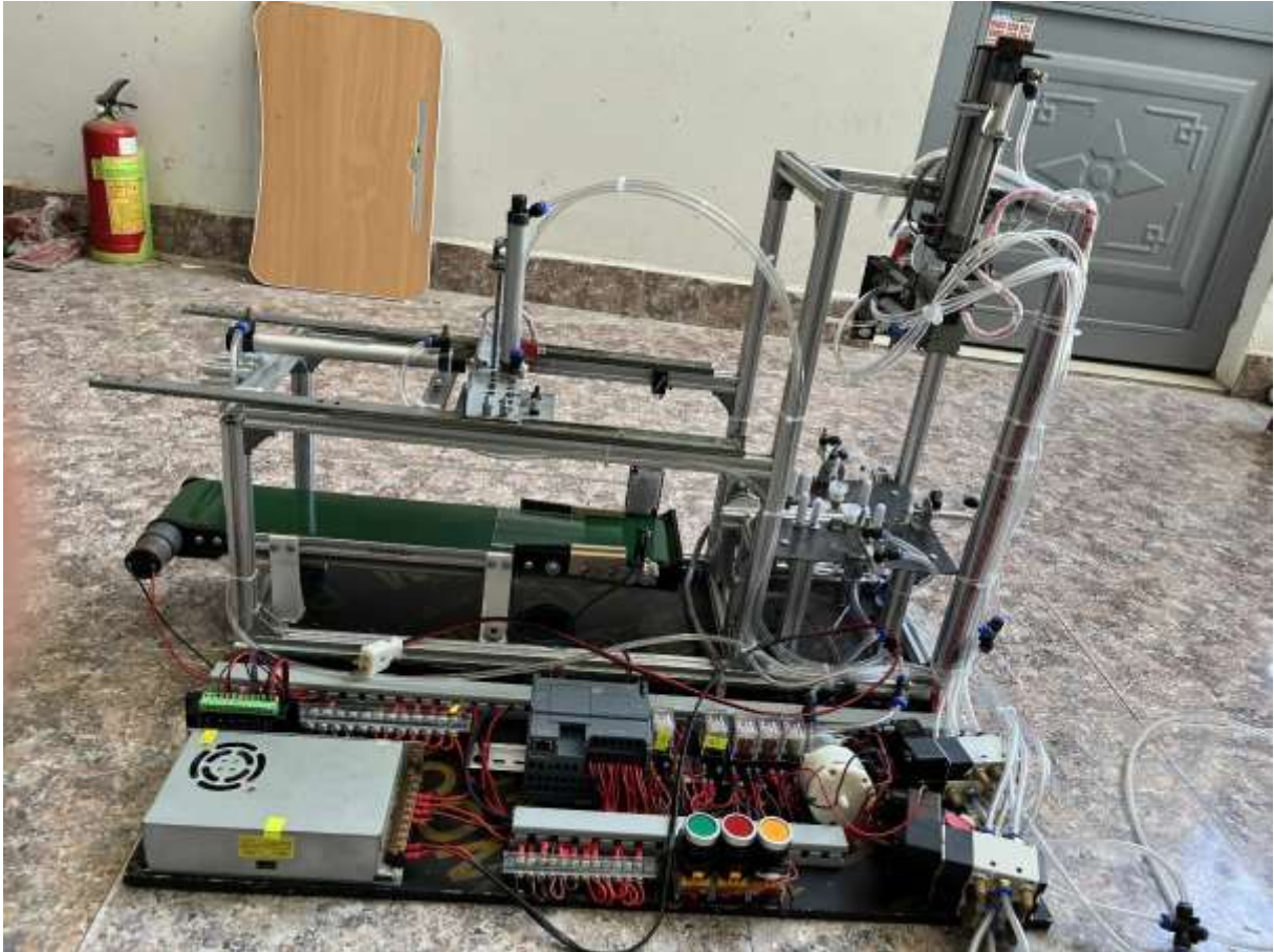
Hình 6.20 Mô hình sau khi đã được lắp ráp và nối dây điện khí nén
