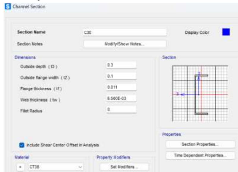
Hình 3.9 Định nghĩa tiết diện dầm dọc đầu van
