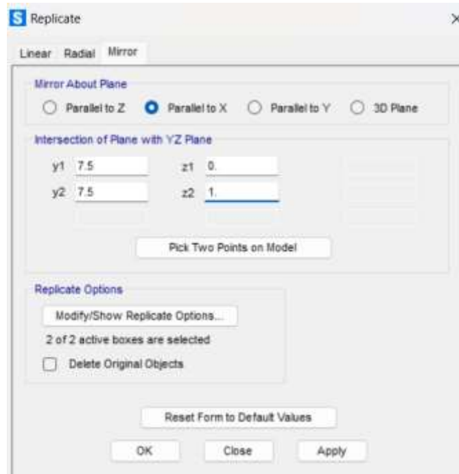
Hình 3.32 Nhân bản đối xứng dầm biên chữ C60 ở phía dương trục Y
