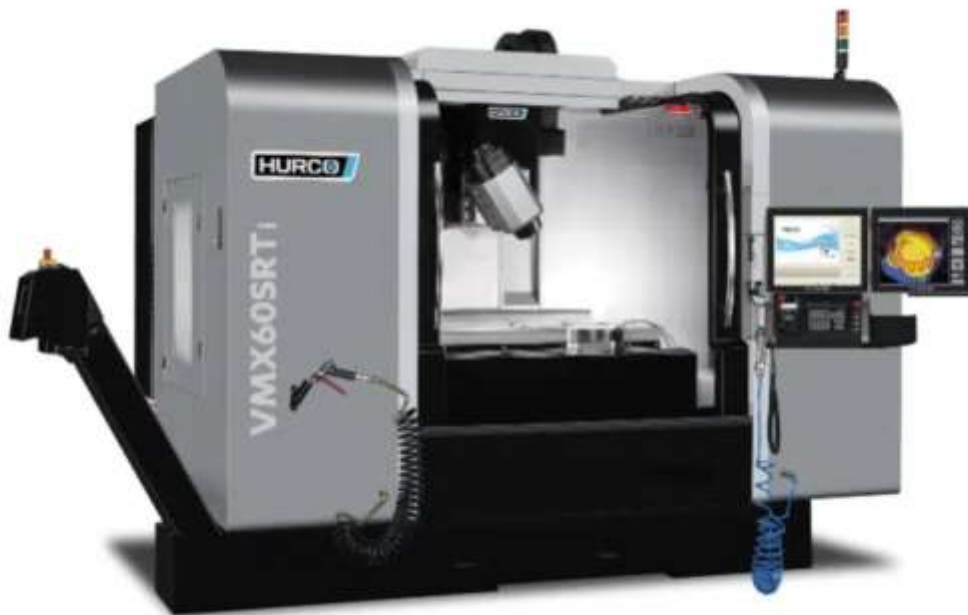
Hình 1.8: Máy CNC 4 trục trang bị đầu xoay quanh trục Y
