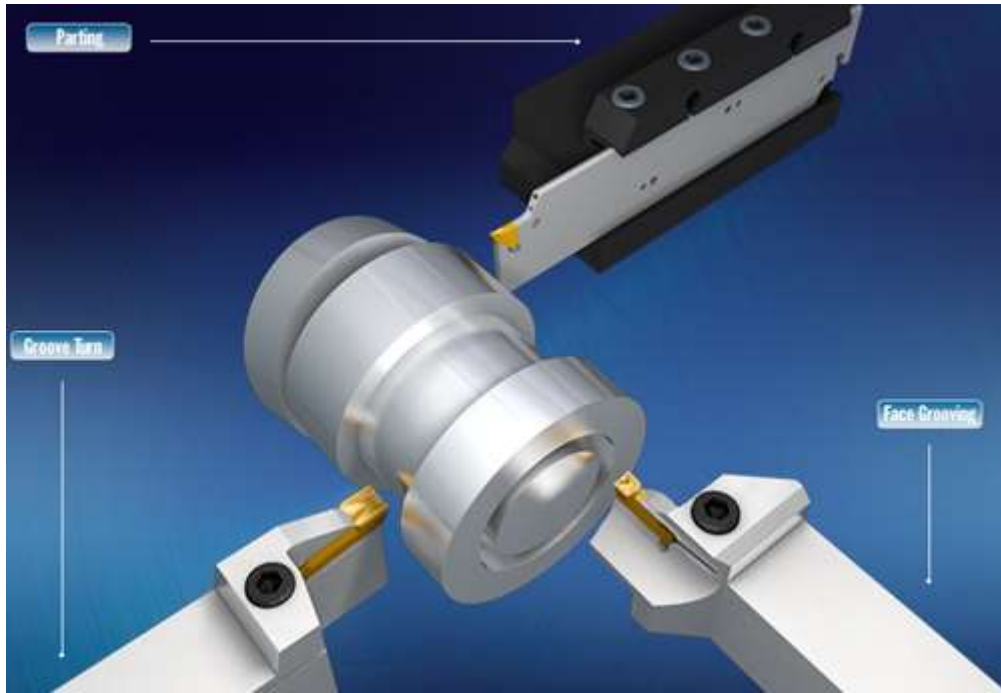
Hình 1.24: Dao tiện rãnh và cắt đứt
