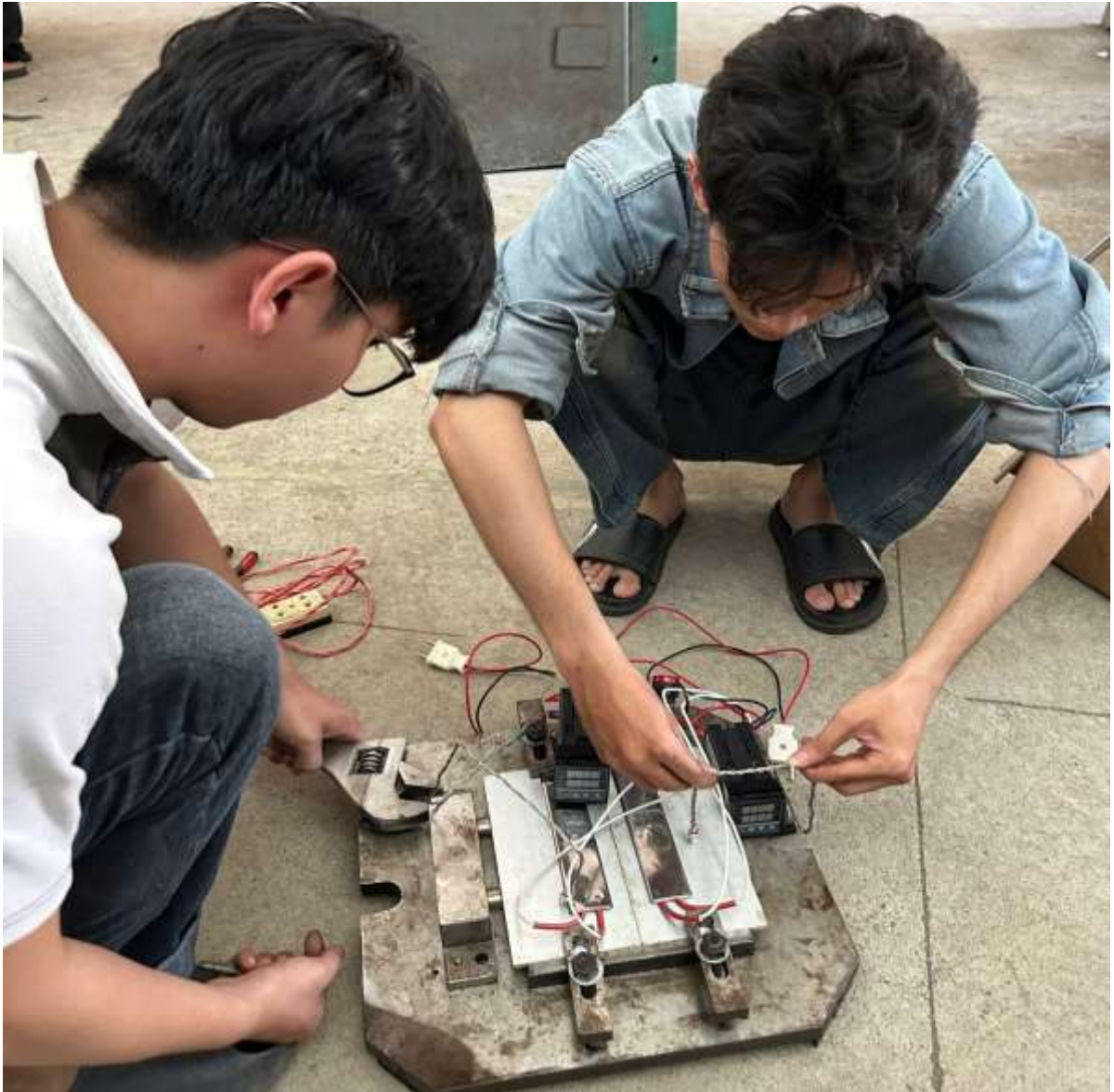
Hình 6. 21 Lắp điện trở gia nhiệt lên đồ gá
