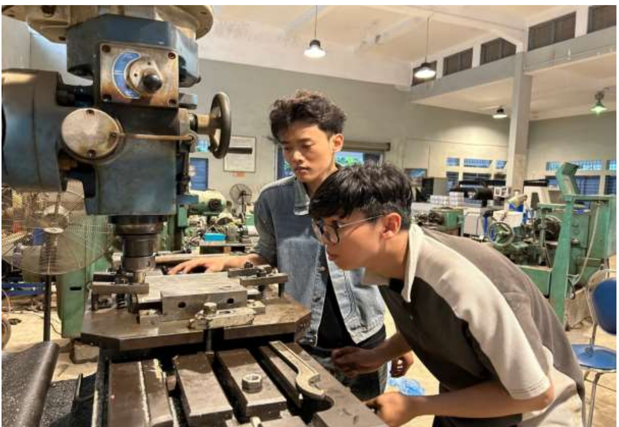
Hình 6. 22 Lắp đồ gá lên máy phay
