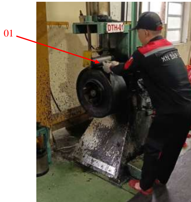
Hình 1.23. Công nhân tiếp xúc rất gần con lăn ép
