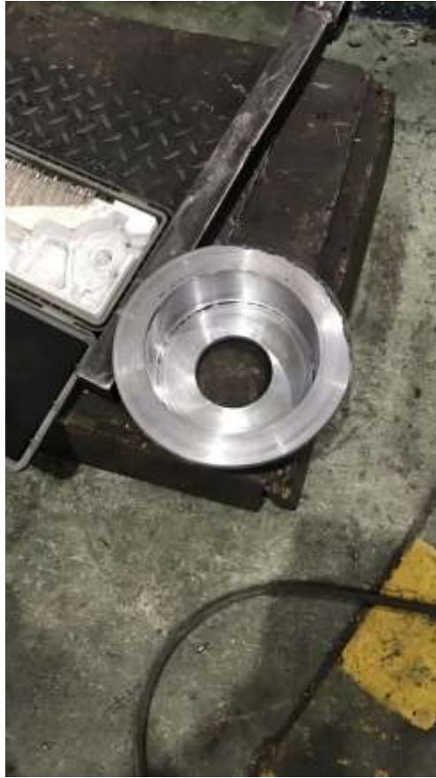
Hình 4.23. Chi tiết lắp ổ bi đỡ được gia công riêng để hàn vào khung máy
