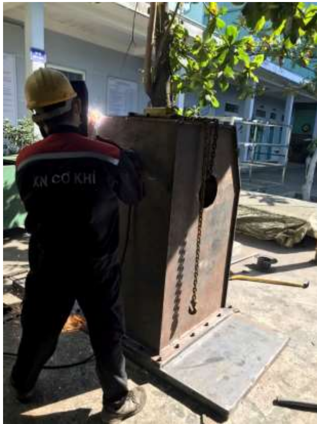
Hình 4.22. Khung máy của cụm máy thành hình đang được gia công
