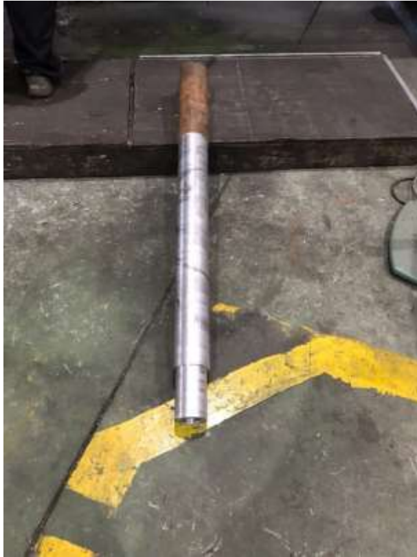
Hình 4.21. Trục chính của cụm máy thành hình đang được gia công
