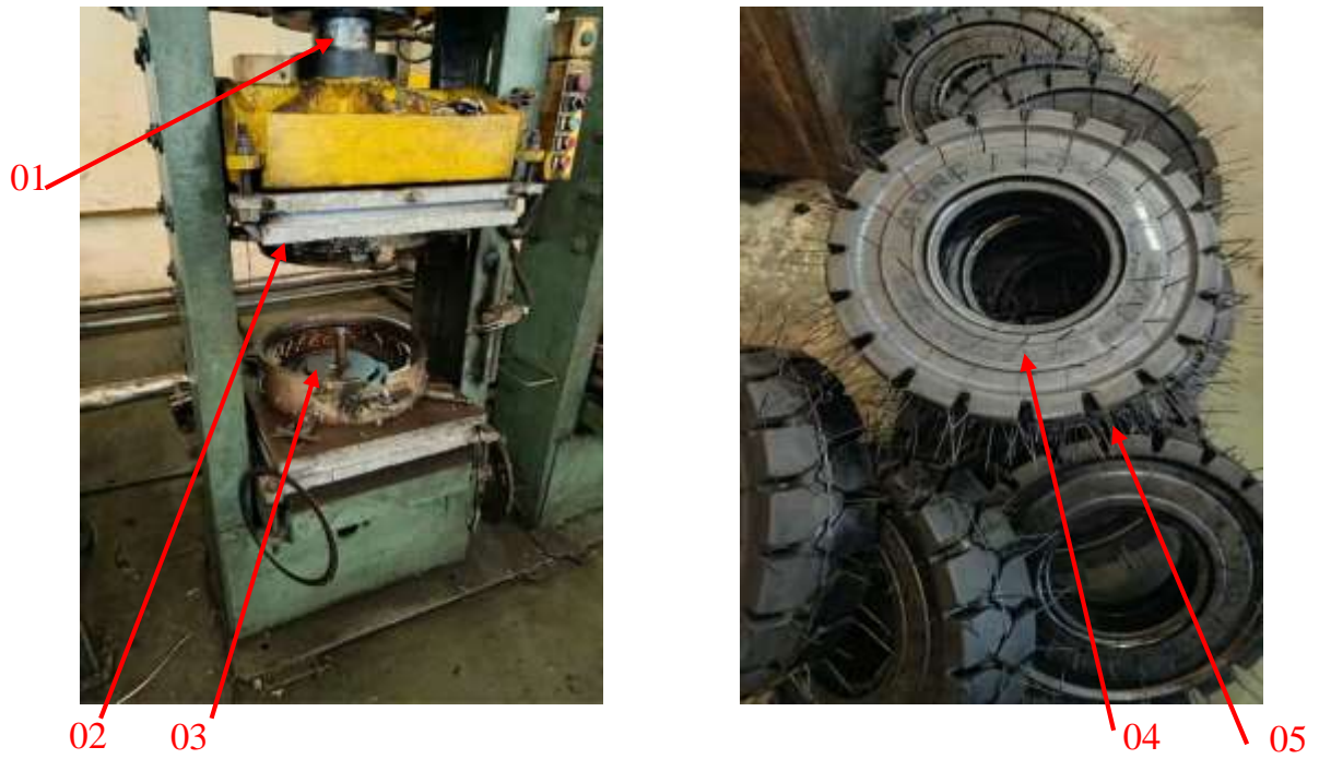
Hình 1.18. Máy lưu hóa và sản phẩm sau khi lưu hóa
