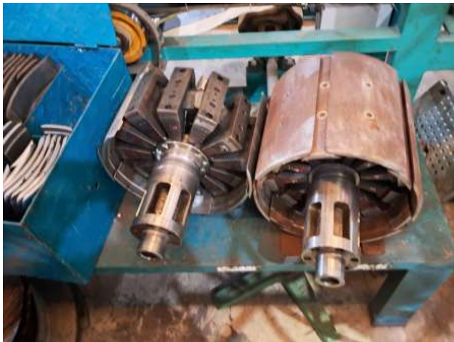
Hình 3.2. Trống thành hình đường kính 305mm của công ty
