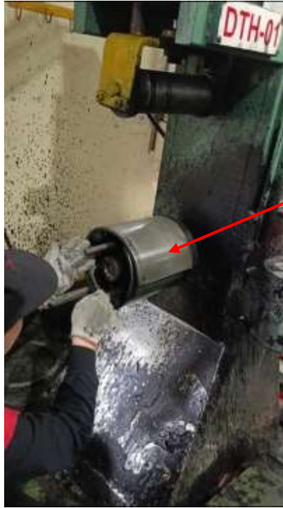
Hình 1.22. Công nhân thực hiện bung trống bằng tay
