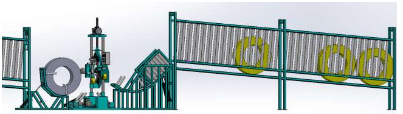
Hình 6.8: Khi cảm biến không phát hiện lốp ở máy, xylanh sẽ đẩy lốp vào máy
