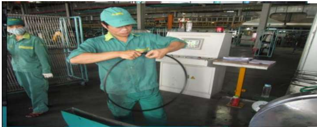
Hình 1.14: Công nhân gia công vòng tanh
