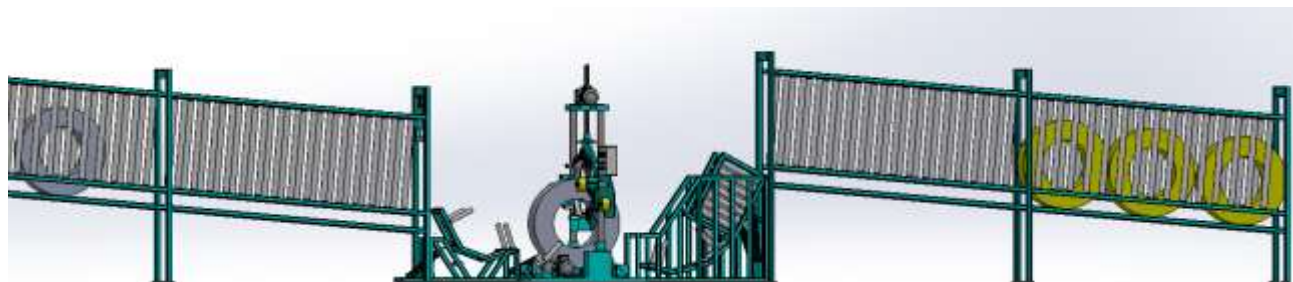
Hình 6.9: Máy bắt đầu quấn sản phẩm và xylanh đẩy lùi về
