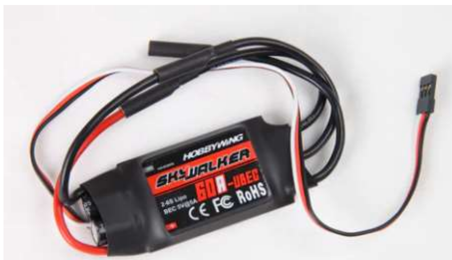
Hình 5. 7 Bộ điều tốc Hobbywing Xrotor 60A
