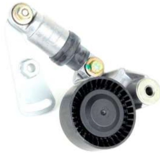
Hình 7. 14 Cơ cấu căng xích bằng thủy lực..
