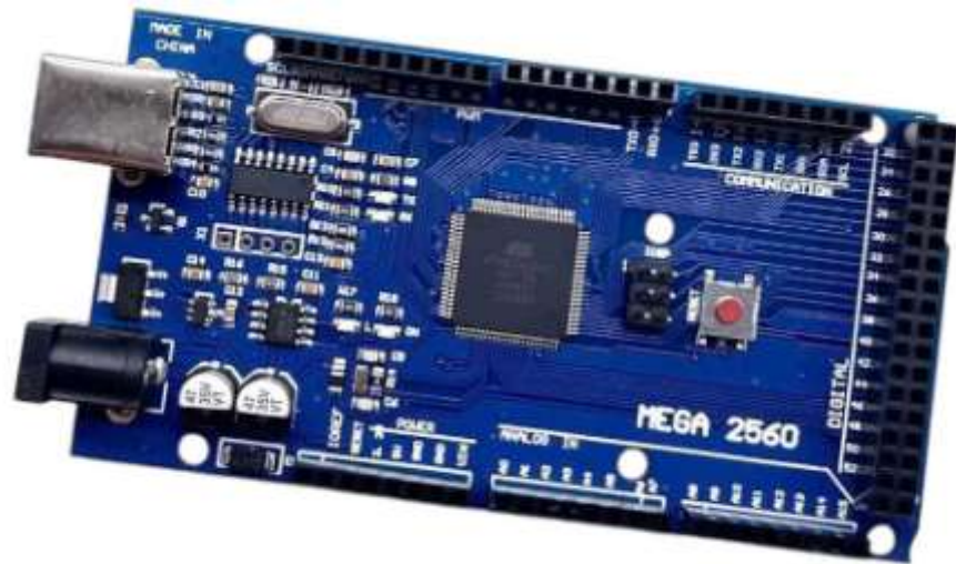
Hình 5. 4 Board mạch Arduino Mega 2560.
