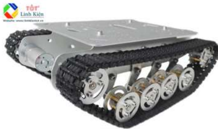
Hình 8. 5 Khung xe làm bằng nhôm.
