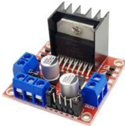
Hình 5. 5 Mạch điều khiển động cơ DC L298N
