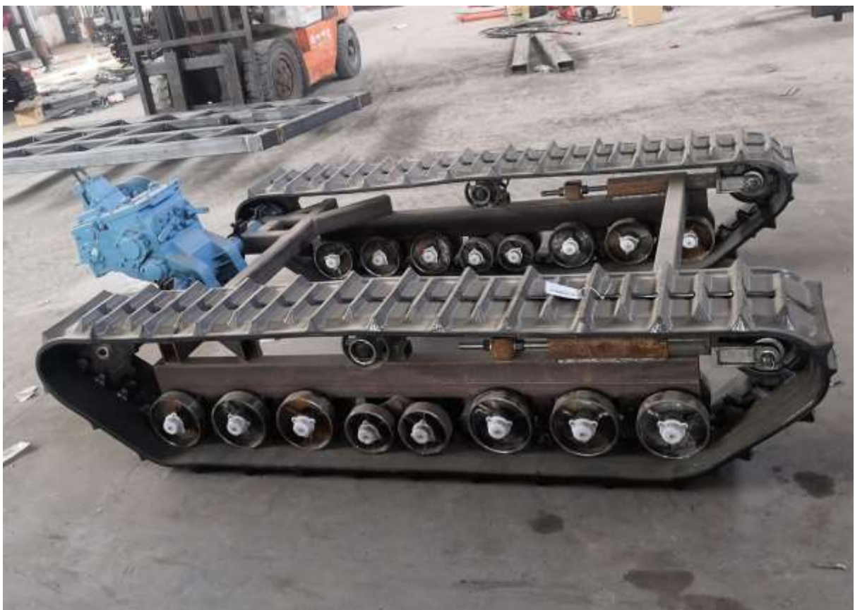
Hình 8. 1 Hệ thống khung treo trong truyền động bánh xích.
