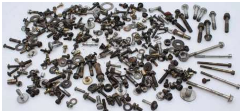
Hình 3.9: Các bộ phận được gia công trên máy tiện Turret
