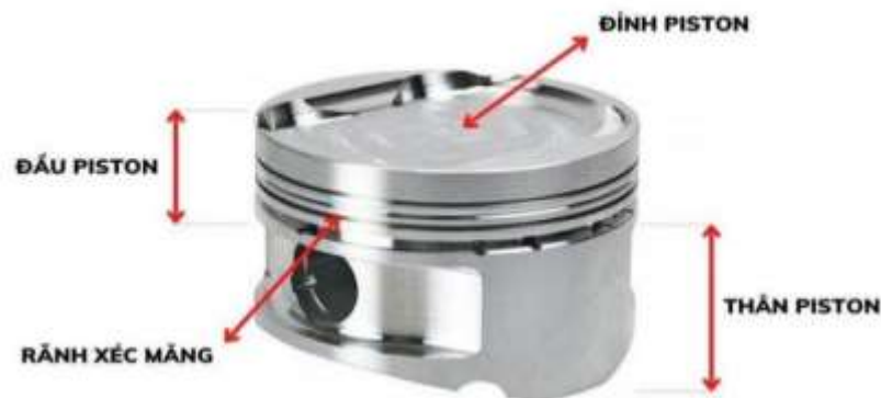
Hình 4.2: Cấu tạo của Piston
