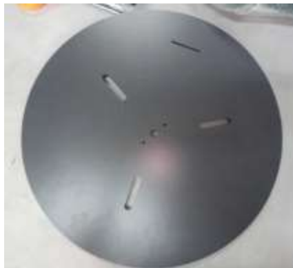
Hình 4-12: Đế bàn xoay sau khi gia công
