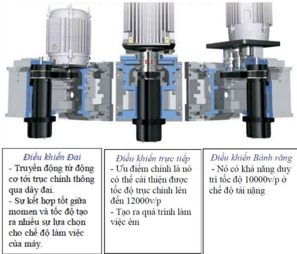
Hình 3-6: Các dạng dẫn động trực chỉnh
