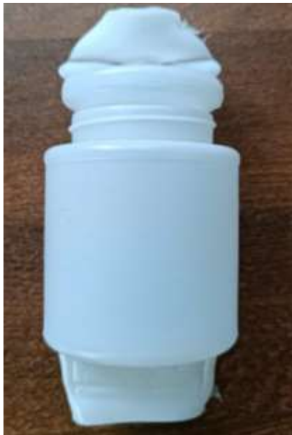
Hình 1.2. Chai nhựa HDPE khi chưa được loại bỏ bavia
