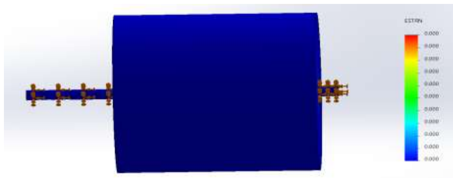
Hình 2.38. Biến dạng tương đối trong tang chủ động
