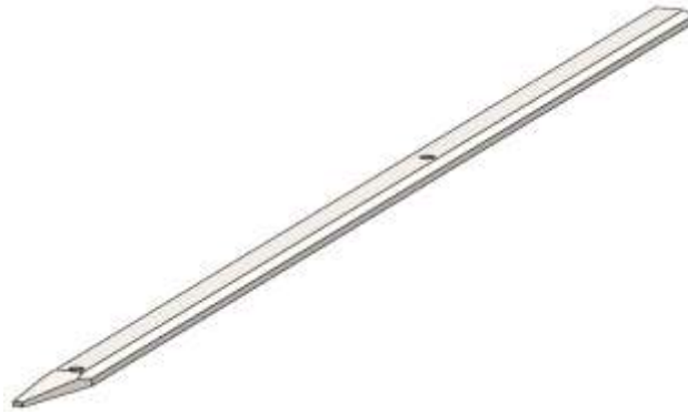
Hình 2.26. Hình dạng thanh dẫn hướng chai
