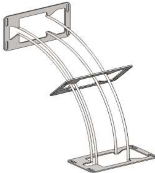
Hình 2.18. Hình dạng máng dẫn chai
