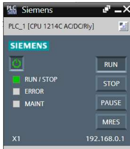
Hình 8.5: CPU PLC ảo đang ở trạng thái RUN
