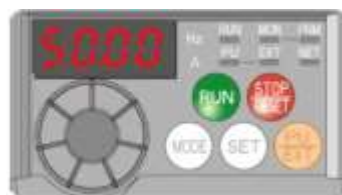
Hình 7.6: Biến tần FR-D740-1.5K
