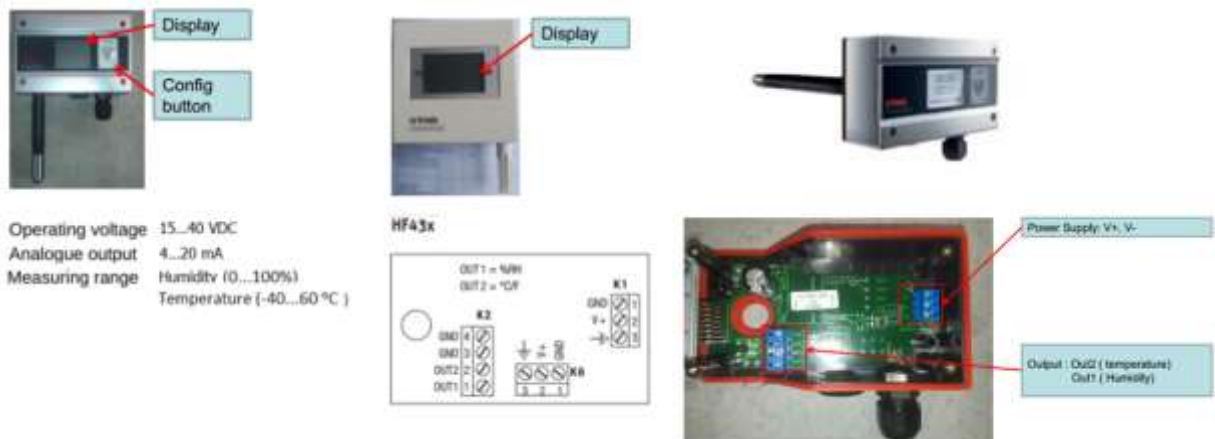
Hình 3.10 Cảm biến nhiệt độ - độ ẩm và sơ đồ đấu nối
