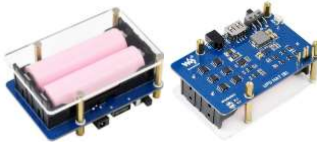
Hình 2.25: Mạch Waveshare UPS HAT (B)
