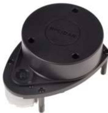
Hình 2.18: Cảm biến RP-LIDAR A1M8
