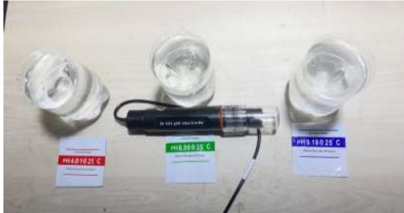
Hình 3.7 Hiệu chuẩn cảm biến PH
