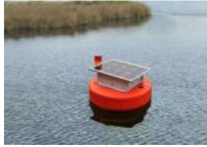
Hình 1.4 Hệ thống quan trắc nước tự động Stepro
