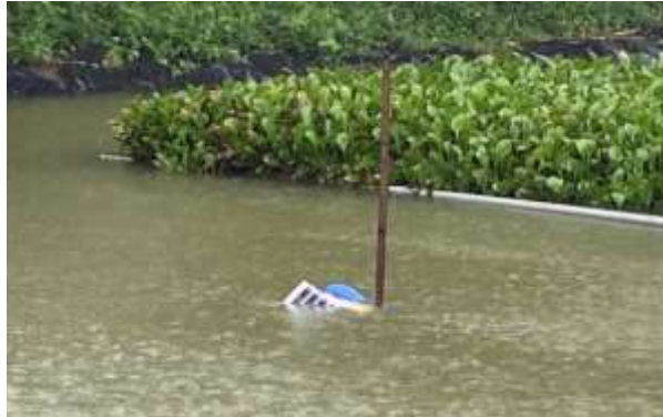
Hình 4.15 Node thu thập dữ liệu khi gặp sự cố
