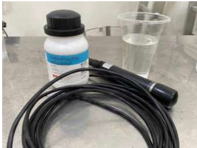
Hình 3.5 Hiệu chuẩn cảm biến DO
