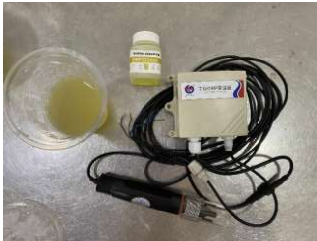
Hình 3.8 Hiệu chuẩn cảm biến ORP
