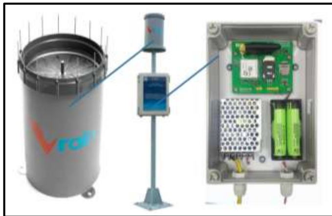
Hình 1.2 Thiết bị IoT đo mưa Vrain
