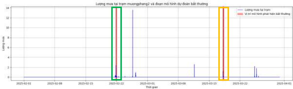
Hình 3.36 Lượng mưa tại trạm và đoạn mô hình dự đoán bất thường tại edge
