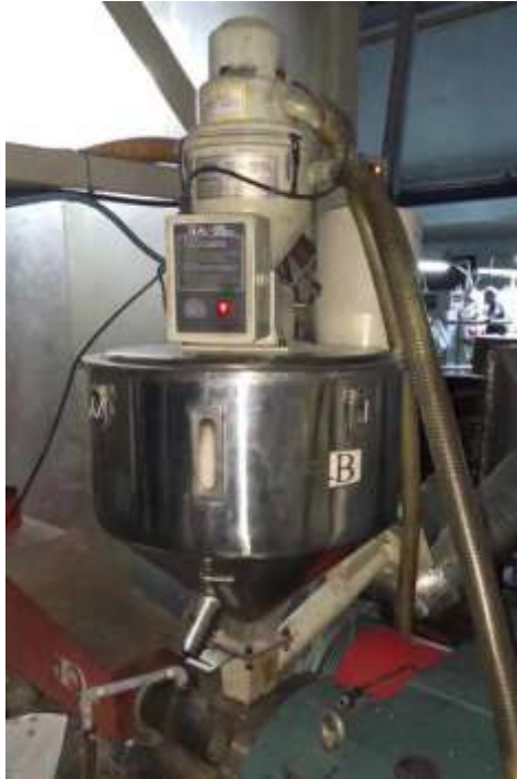
Hình 2.7 Hệ thống phễu nhập liệu
