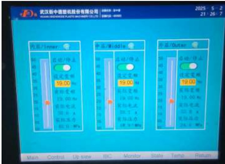
Hình 2.50 Màn hình điều khiển tốc độ đùn
