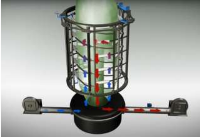
Hình 2.24 Cấu tạo hệ thống gió nội IBC
