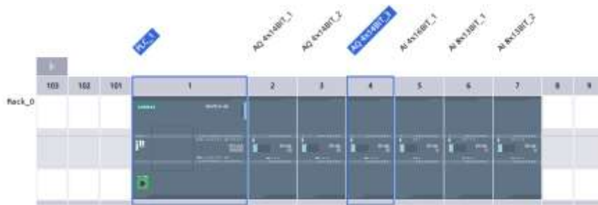
Hình 3.9 PLC S7-1200 CPU kết nối các module IO
