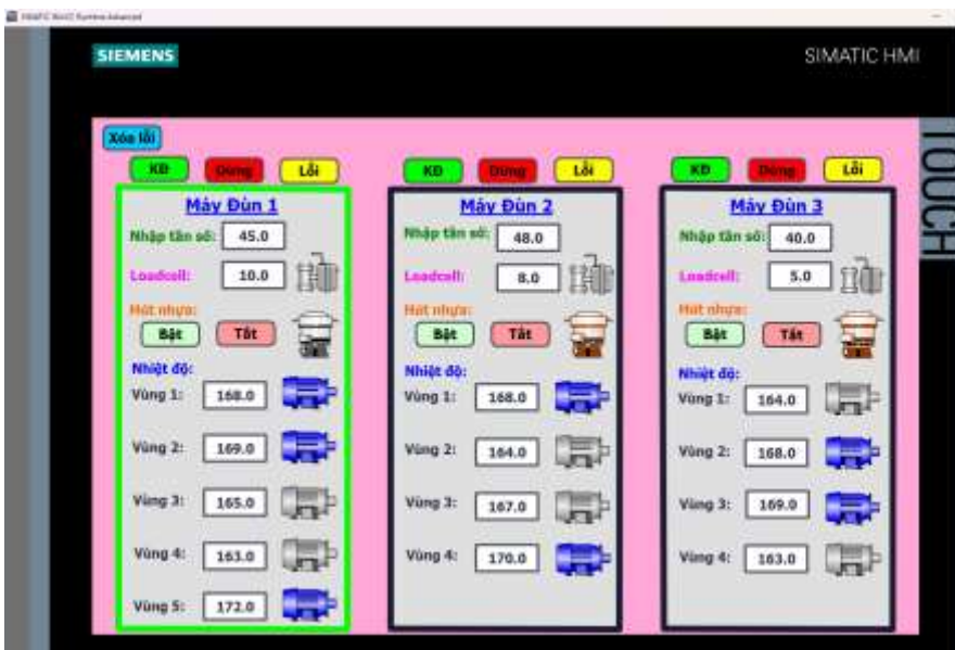
Hình 3.21 Giao diện HMI khi cho dừng 2 máy đùn
