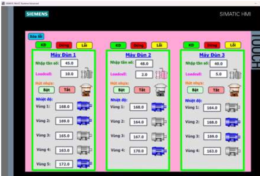
Hình 3.20 Giao diện HMI khi đã bắt đầu chạy
