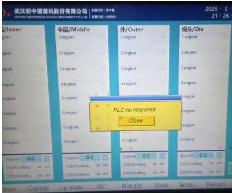
Hình 2.51 Màn hình điều khiển nhiệt độ đùn
