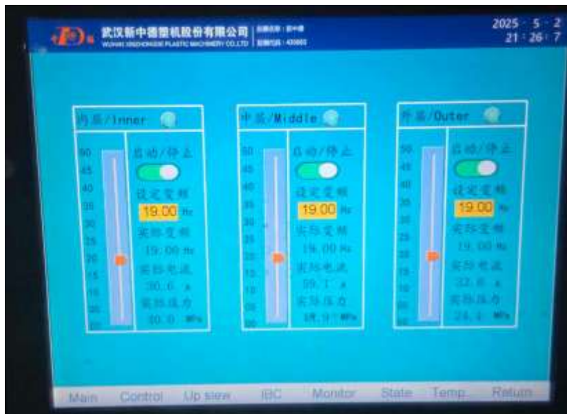
Hình 2.21 Bảng điều khiển tốc độ máy đùn
