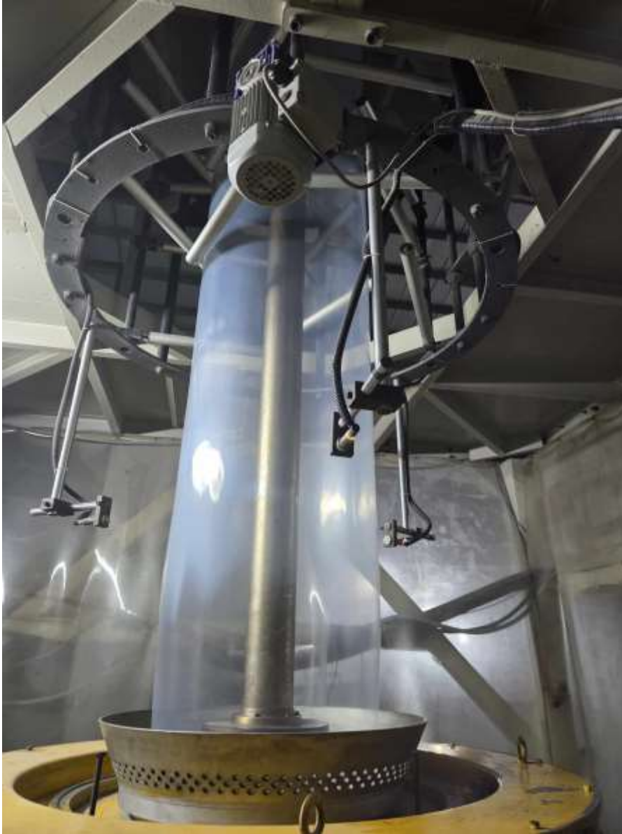
Hình 2.27 3 cảm biến khoảng cách của máy thổi màng
