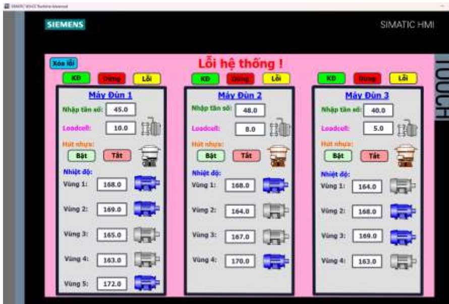
Hình 3.22 Giao diện HMI khi có lỗi
