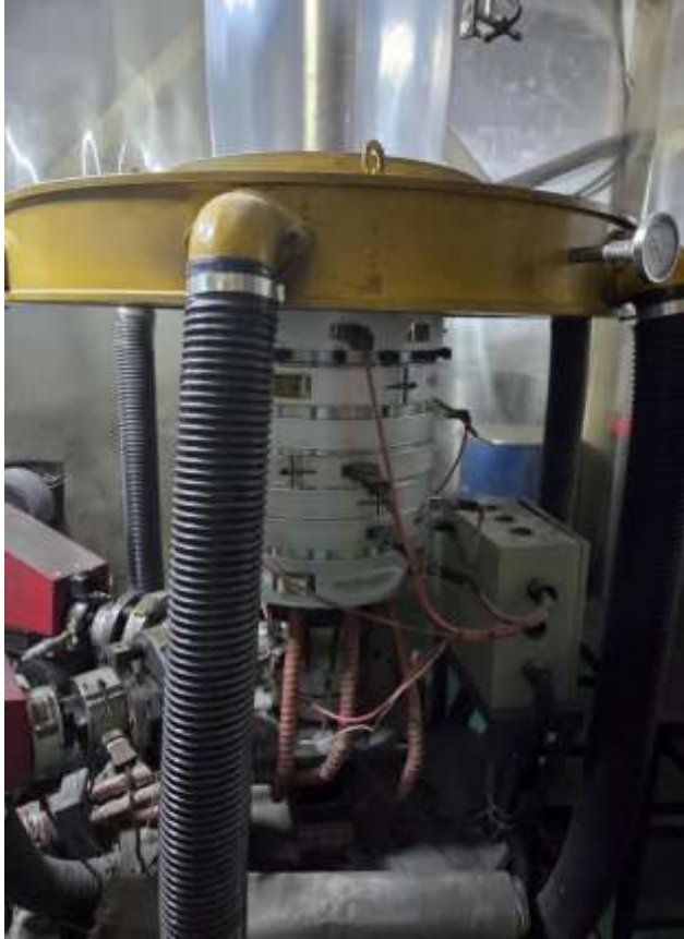
Hình 2.23 Hệ dầu đùn của máy thổi 3 lớp
