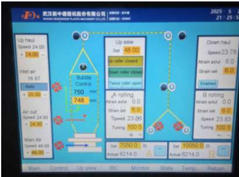
Hình 2.46 Màn hình điều khiển chính
