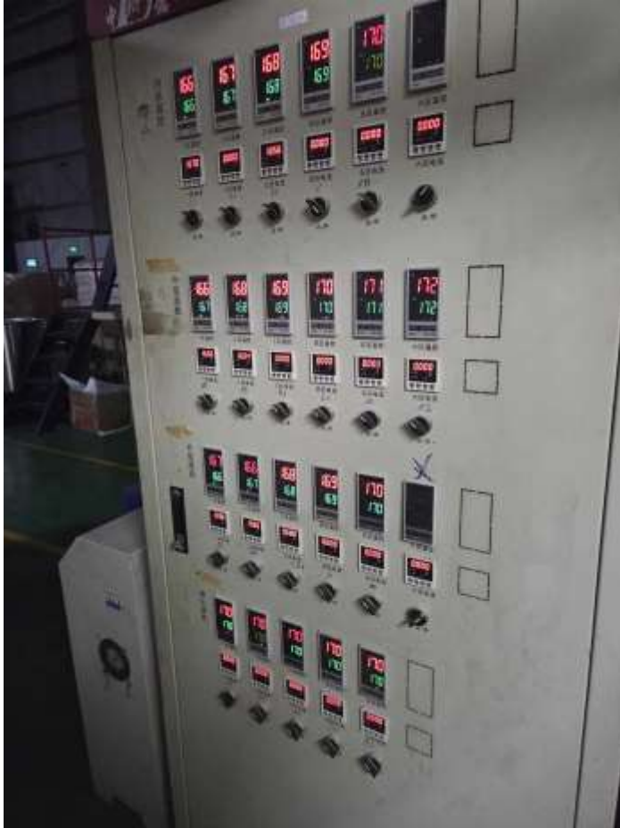
Hình 2.20 Module hiển thị nhiệt từng vùng của máy đùn
