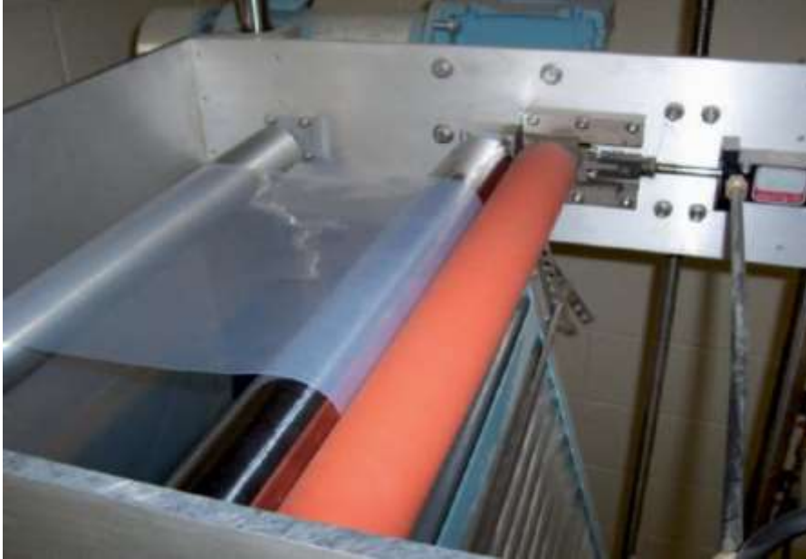
Hình 2.35 Cặp trục Nip-rolls kéo trên
