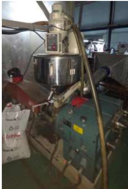
Hình 2.3 Máy đùn lớp giữa
