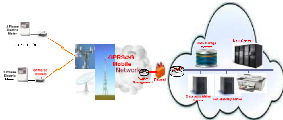
Hình 2.2: Mô hình hệ thống đo xa GPRS/3G
